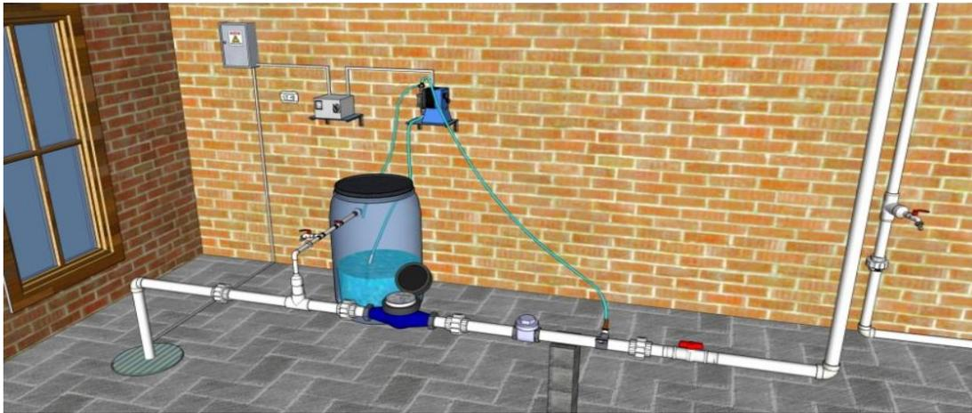
Se propone la cloración del agua proveniente del pozo El Bosque, esto empleando un hipoclorador de carga constante, el cual bombeará una dosis de cloro agregado equivalente a 2 mg/l, paralelamente a las 16 horas de bombeo que operará el pozo el bosque, con el objetivo de asegurar la completa desinfección del agua y evitar alteraciones en la potabilización de la misma.
