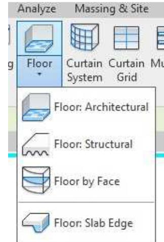
Figura 26. Botón de creación de suelos, fuente: Revit 2019
