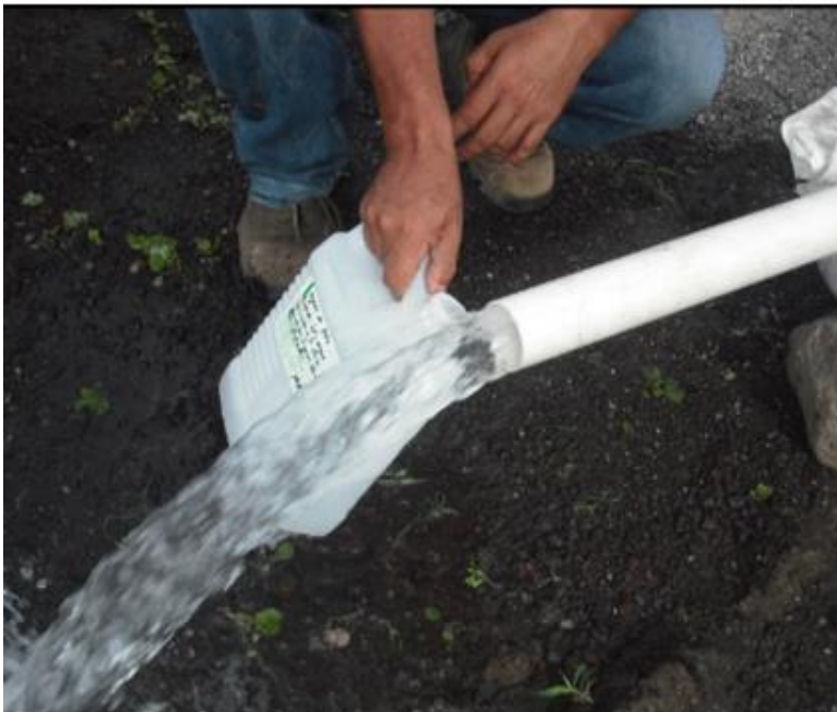
Fotografía 1 Toma de muestra de agua durante prueba de bombeo
