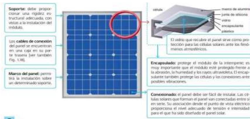
Ilustración 11. Constitución de un panel.
