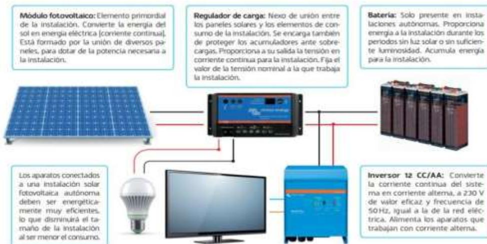
Ilustración 10. Componentes de Sistema Solar Fotovoltaico.
