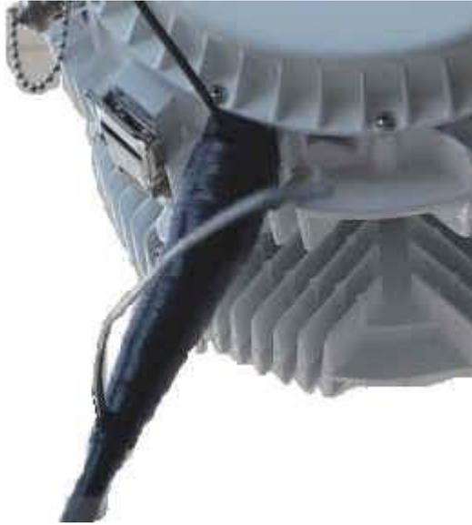
Figura 28. Apariencia del conector exterior impermeabilizado. Extraído de [11]
