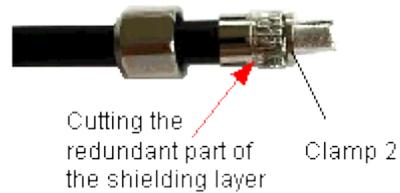
Figura 18 Ajustando abrazadera 2. Extraído de [11]
