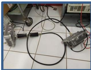
Conexión de ODUS con cable RG8 y conector N
