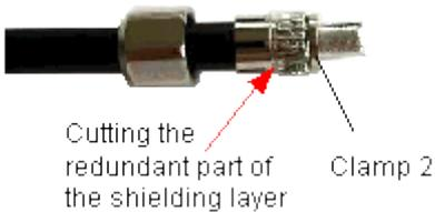
Figura 12 Ajustando abrazadera 2. Extraído de [11]
