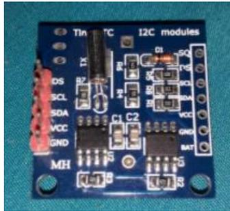
Figura 16. Módulo RTC DS-1307 Fuente: Autor.
