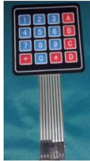
Figura 15. Teclado de membrana 4x4. Fuente: Autor
