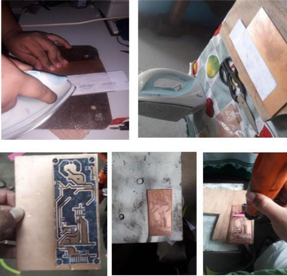
Planchado y perforado de la tarjeta pcb para la implementación del prototipo
