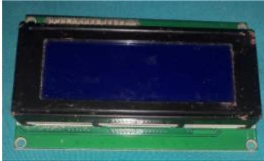
*Figura 13. Display LCD 20x4. Fuente: Autor.*
