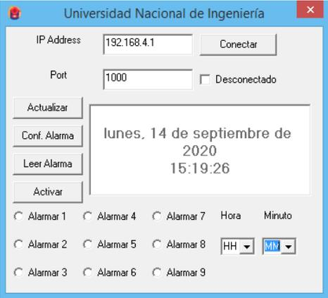
Con el ejecutable abierto, el primer paso para acceder a las funciones del controlador será establecer comunicación con el controlador y para ello solo basta con ingresar en los campo de IP
