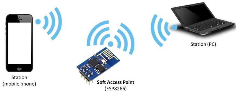
Figura 18. Módulo Esp-01 operando como punto de acceso. Fuente: <https://esp8266-arduino-spanish.readthedocs.io/es/latest/esp8266wifi/readme.html>
