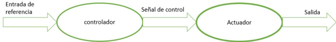
Figura 2. Diagrama de control ON/OFF lazo abierto. Fuente: autor.
