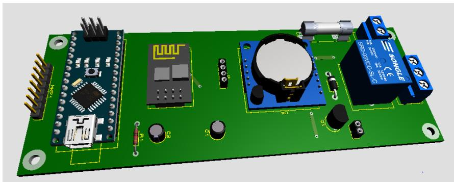
Figura 38. Diseño del prototipo en 3D, software proteus 8.9. Fuente: Autor
