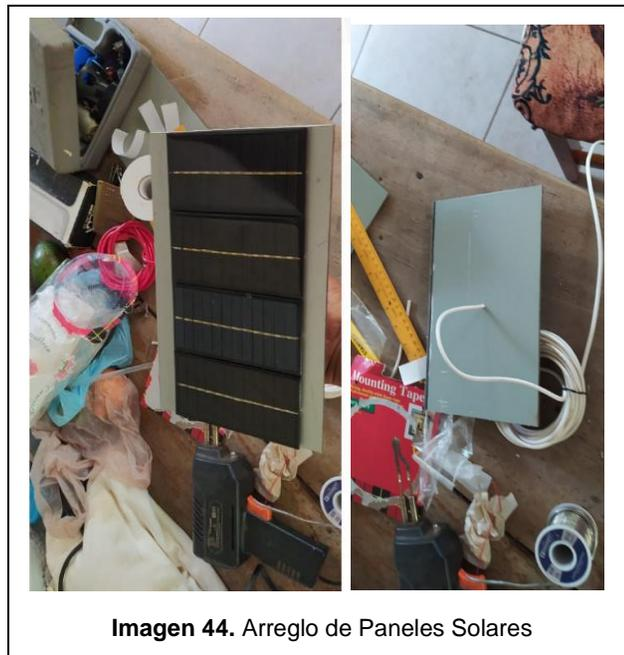
Una vez interconectado los paneles solares se fijaron en un pedazo de lámina dando la perspectiva de ser un solo panel sacando de ellos y por medio de la lámina un cable donde serían los puros donde se alimentaria la tarjeta que estaría dentro del cubo de las baterías este cable es con el fin de ubicar el panel en cualquier posición donde convenga que entra mayor influencia solar.
