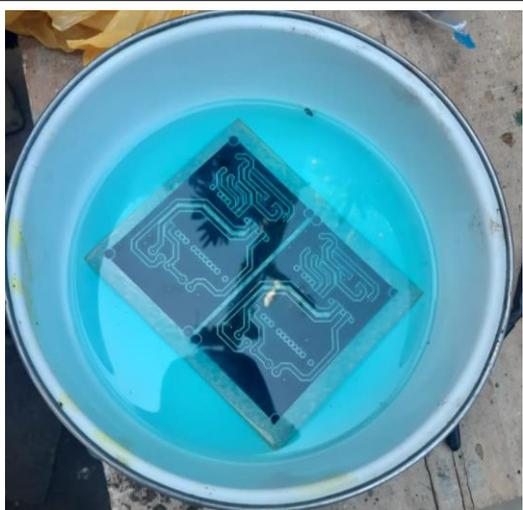
**Imagen 36.** *Proceso de atacado de circuito en Acido*
