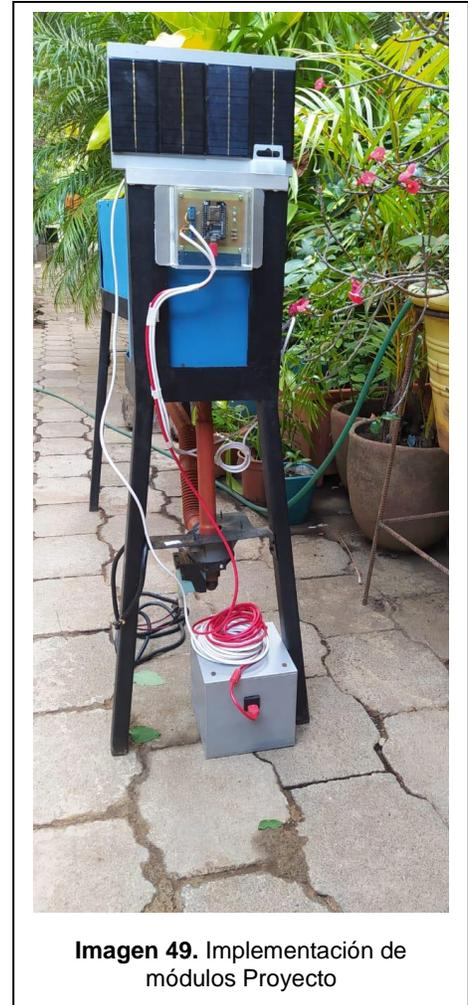
Por otra parte la manipulación del banco de baterías y paneles solares es de fácil traslado y posicionamiento según el ambiente con el objetivo de posicionar en la parte más adecuada según la incidencia solar. La alimentación por medio de las baterías es el principal principio presentado puesto que en la parte física o real existen muchas plantas de tratamiento que no presentan condiciones eléctricas.
