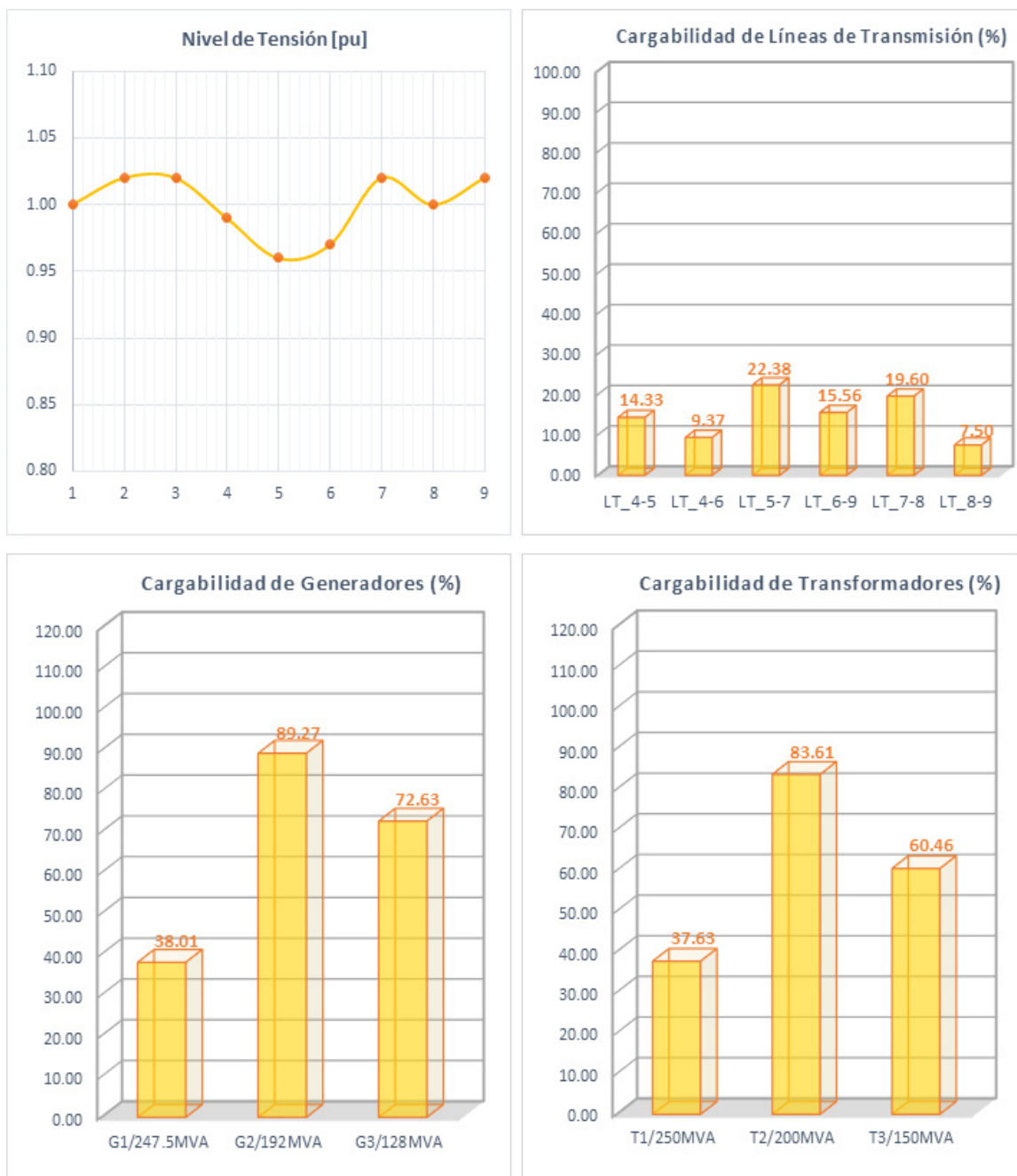
Figura 6: Resultados del Flujo de Carga en Corriente Alterna IEEE 9 Barras
