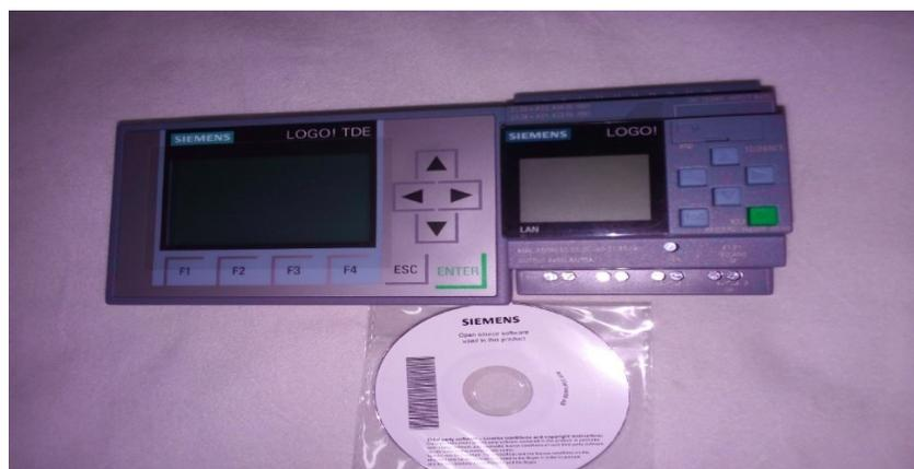
Figura 40. Pantalla LOGO TDE visualizador de textos siemens y LOGO V8. (siemens, siemens , 2018)
