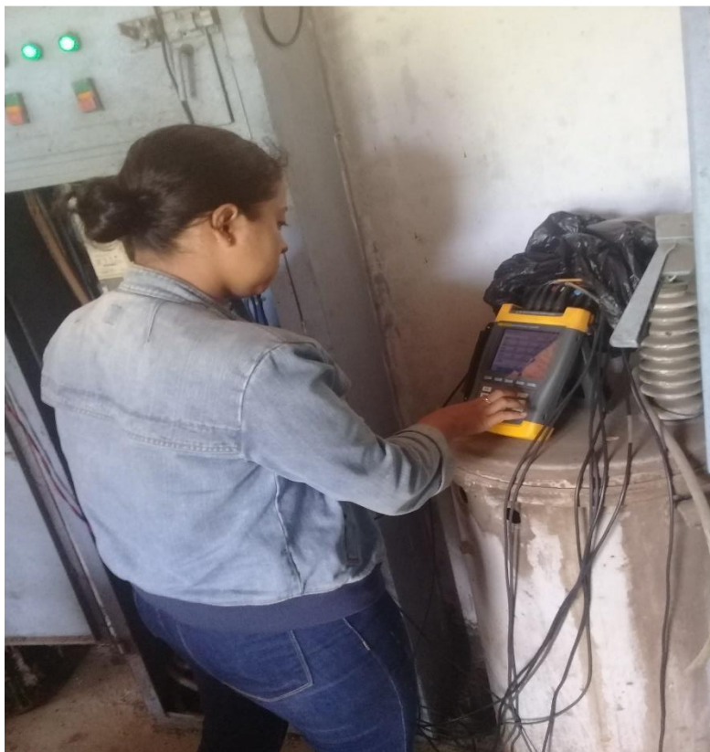
Instalación de equipo de medición en main breakers.
