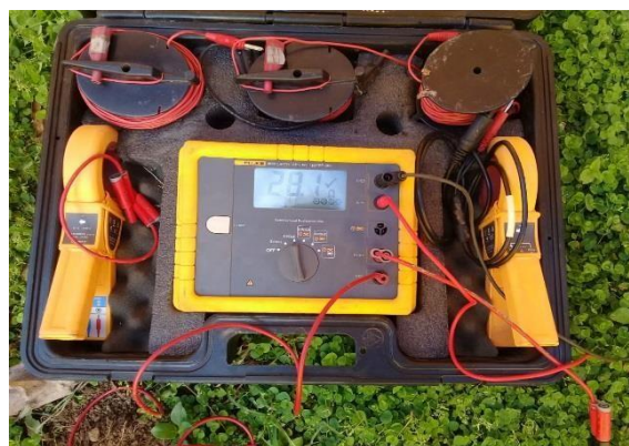
Ilustración 17. Medición PT transformadores y resultado.
