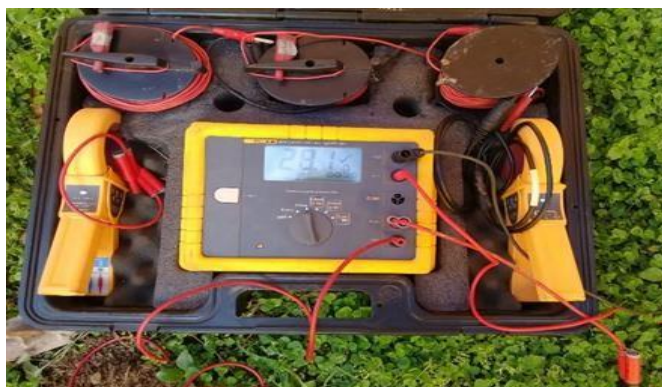
Ilustración 16. Medición de la resistencia del terreno.
