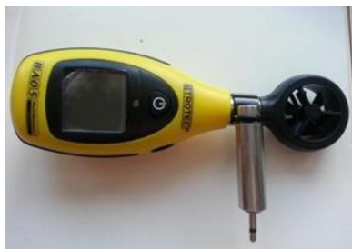
l Figura 12. Vista general del Transductor de fuerza del viento con soporte 1400-20
