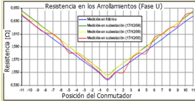
**Figura 15.** Grafica de la medición de la resistencia de CC en los distintos taps de un transformador de potencia
