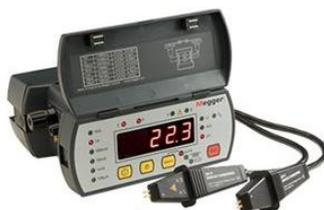
**Figura 32.** Equipo para medir resistencias de bajo valor.
