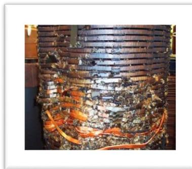
**Figura 10.** Los esfuerzos electromecánicos originadas por la corriente de fallo provoca la deformación del devanado
