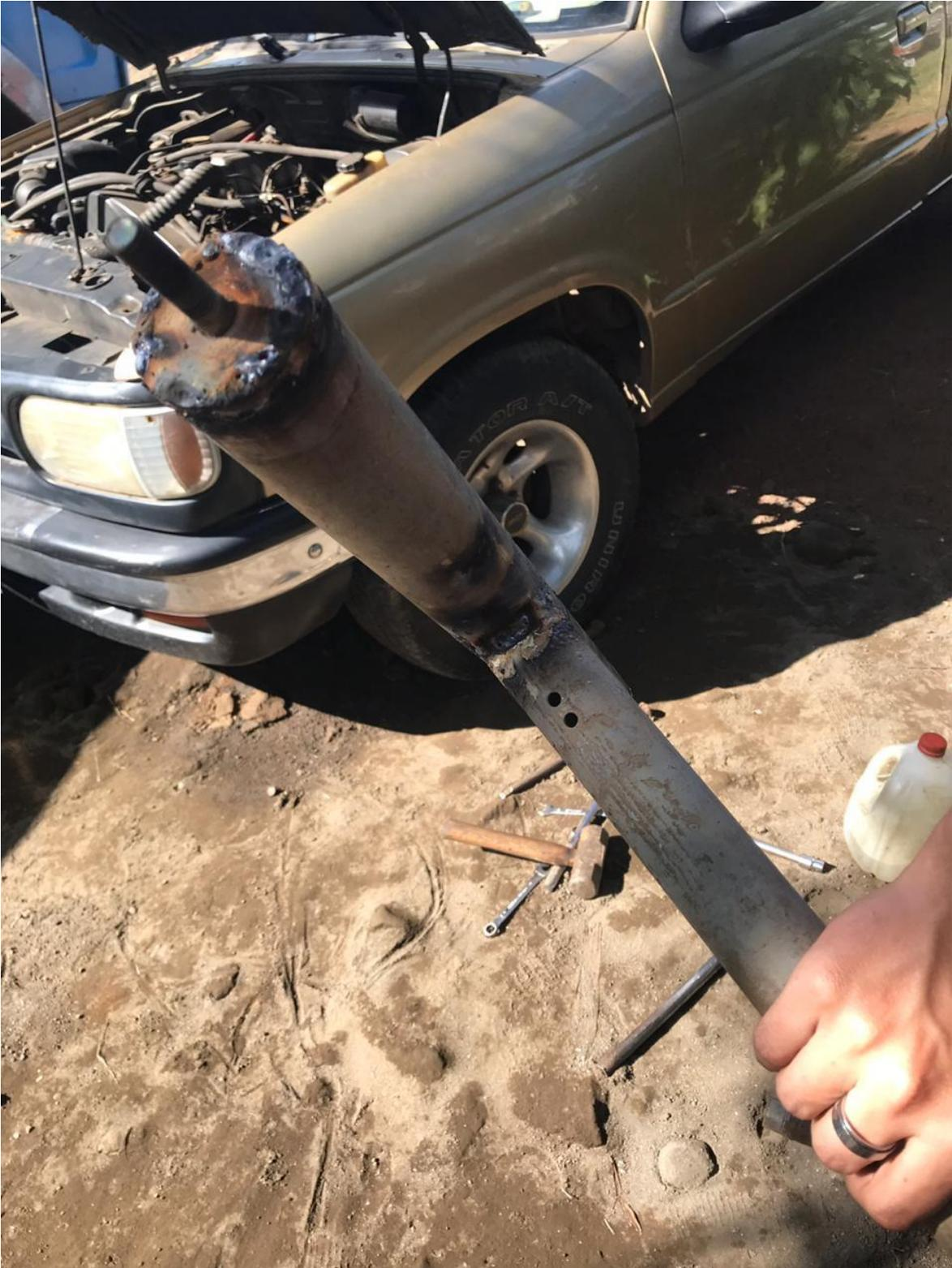
Soldadura termina, ahí se muestra el perno donde va montada las llantas traseras.
