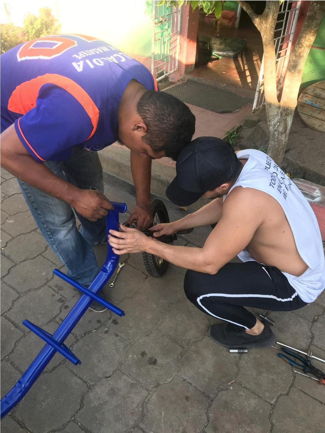
Ensamblando llanta delantera al chasis.
