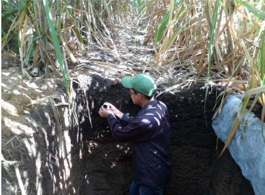
**Imagen 16.** Uso del cilindro para determinación de densidad aparente
