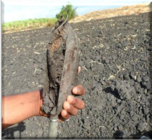
**Imagen 1.** Extracción de de suelo con barreno edafológico
