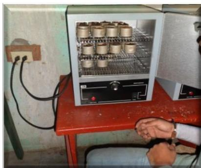
**Imagen 4.** Secado de muestras con horno a 105 °C por 24 hrs
