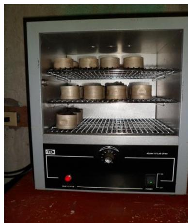
**Imagen 13.** Secado de muestras de suelo a capacidad de campo a 105 °C por 24 horas.
