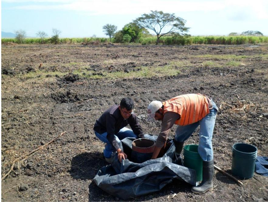
**Imagen 14.** Instalación de los cilindros concéntricos, se usa plástico para controlar que la prueba inicie en simultaneo con los tres cilindros
