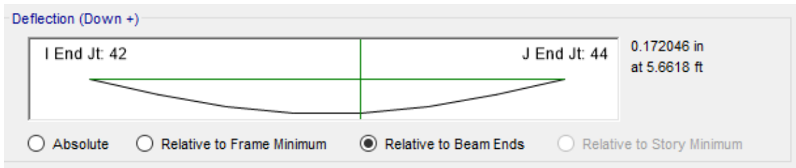
Figura 5.37. Deflexión máxima en la viga W8X13
