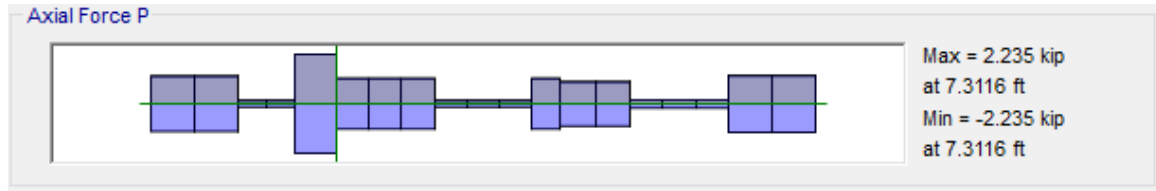
Figura 5.23. Carga axial máxima actuante en viga W10x26
