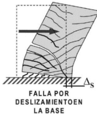
**Figura 15:** Falla por deslizamiento. Tomado de: (DAMIAN, 2017, pág. 3)
