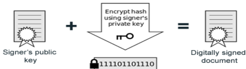
Ilustración 21 aplicación de firma digital
