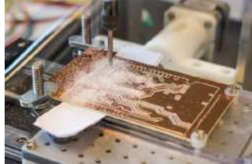
*Figura 19: CNC fresadora aplicada a PCB, tomado de [22].*
