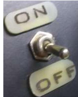
Figura 15: Accionador de palanca.
