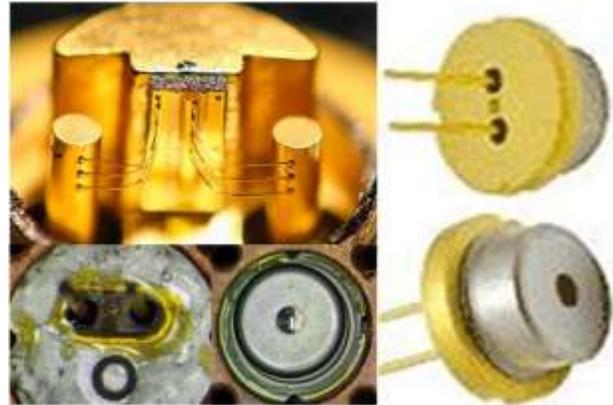
Figura 24: Diodo láser Nichia NUBM44-V2, tomado de [46].
