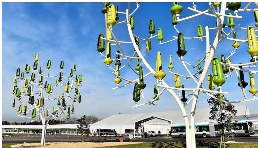
Figura 27. Aerogenerador Wind - tree
