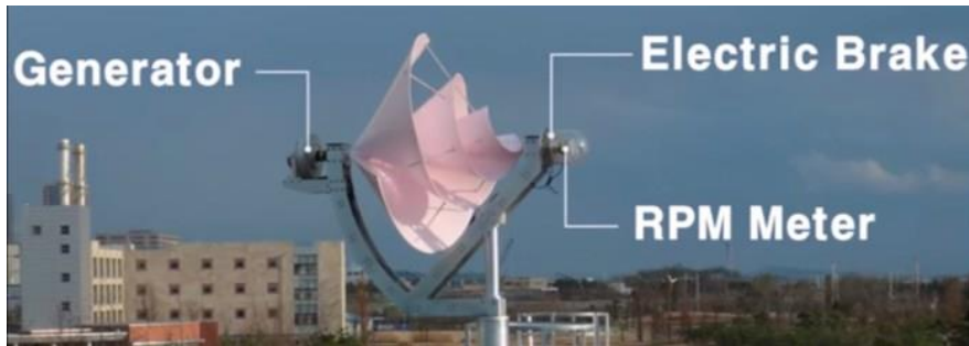
Figura 28. Aerogenerador Liam F1
