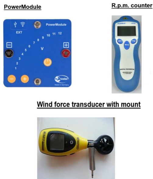
Figura 32. Componentes del módulo Lexsolar – Wind Professional (3)
