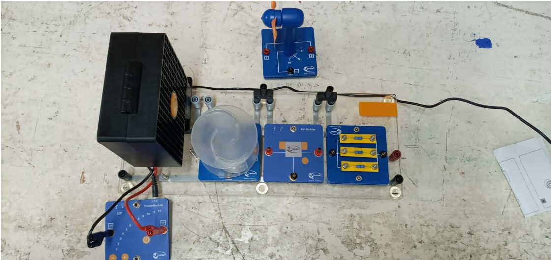
Figura 40. Turbina de eje vertical con cargas resistiva (1)
