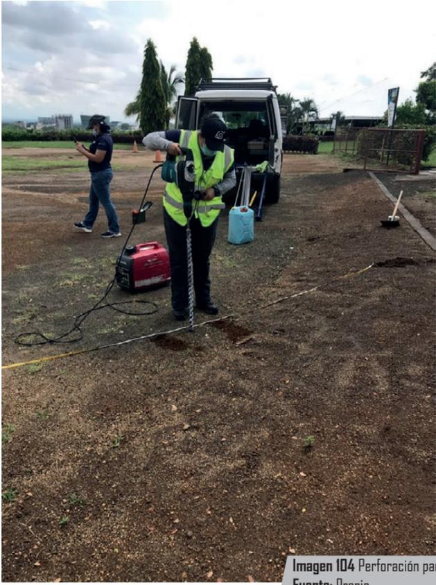
Imagen 104 Perforación para dipolos
