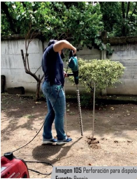
Imagen 105 Perforación para dipolo
