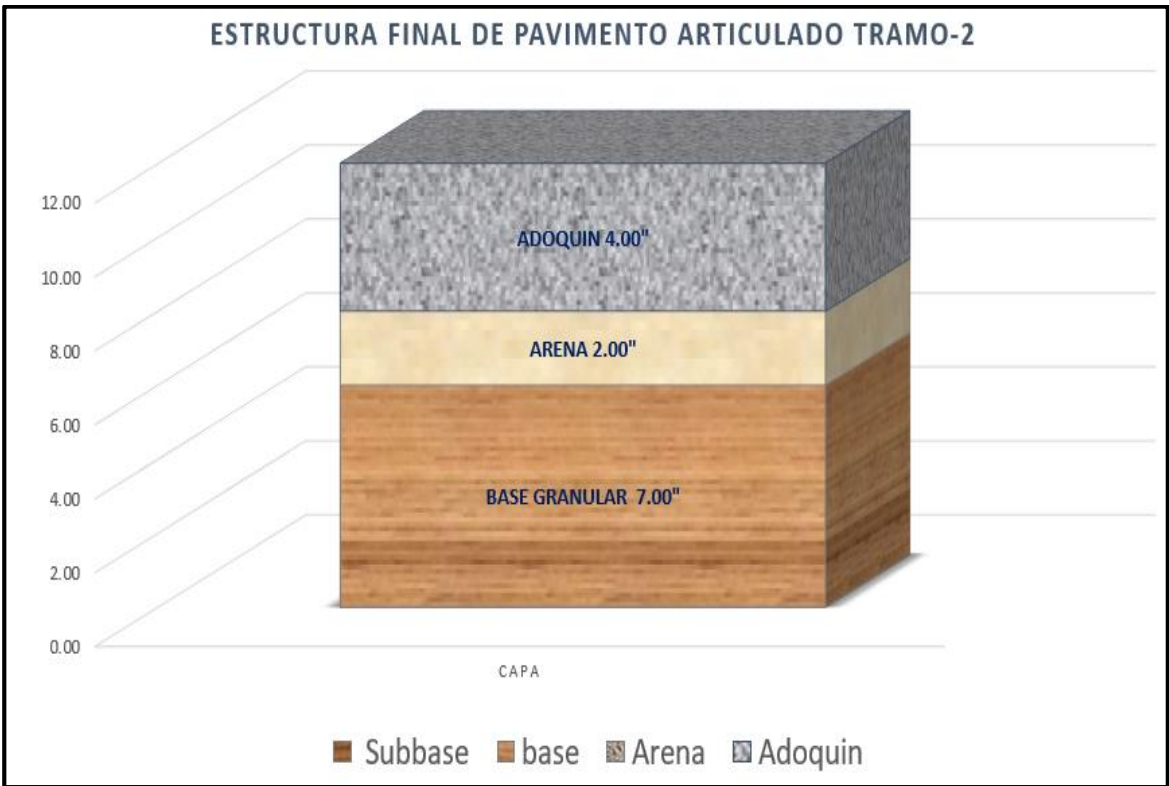
Figura- 22: Estructura Final de Pavimento (tramo-2).
