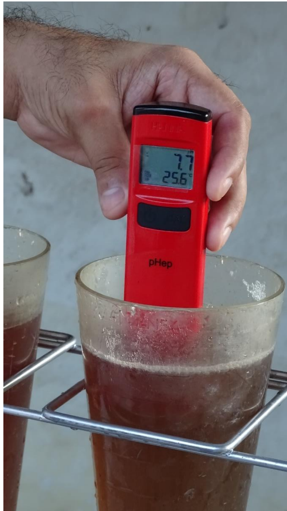
Figura K-13: Medición de pH y Temperatura en el Efluente
