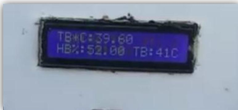
Imagen 78 muestra de lecturas de sensores en pantalla LCD
