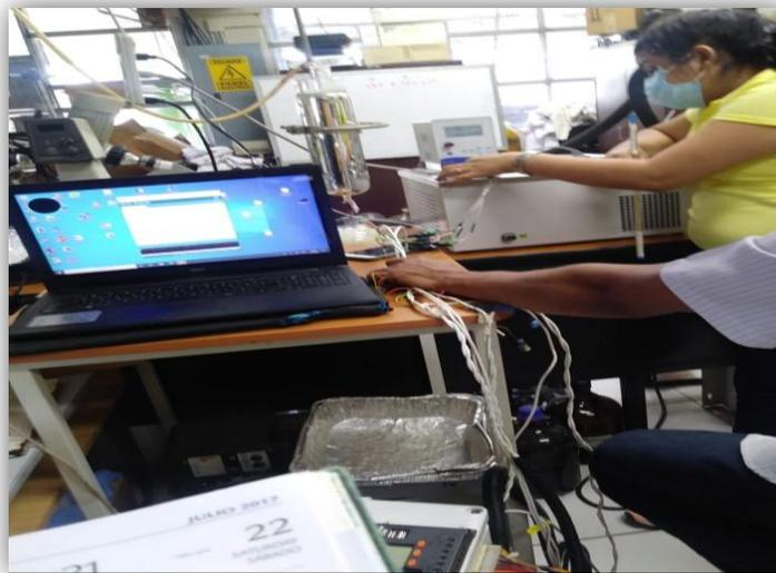
**Imagen 56 comparación de RTC con respecto a equipo baño térmico**
