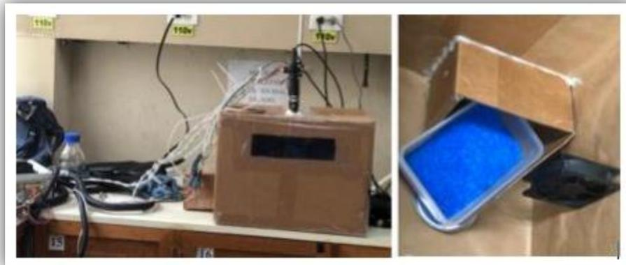
**Imagen 59 sensores de humedad relativa VS sonda testo**
