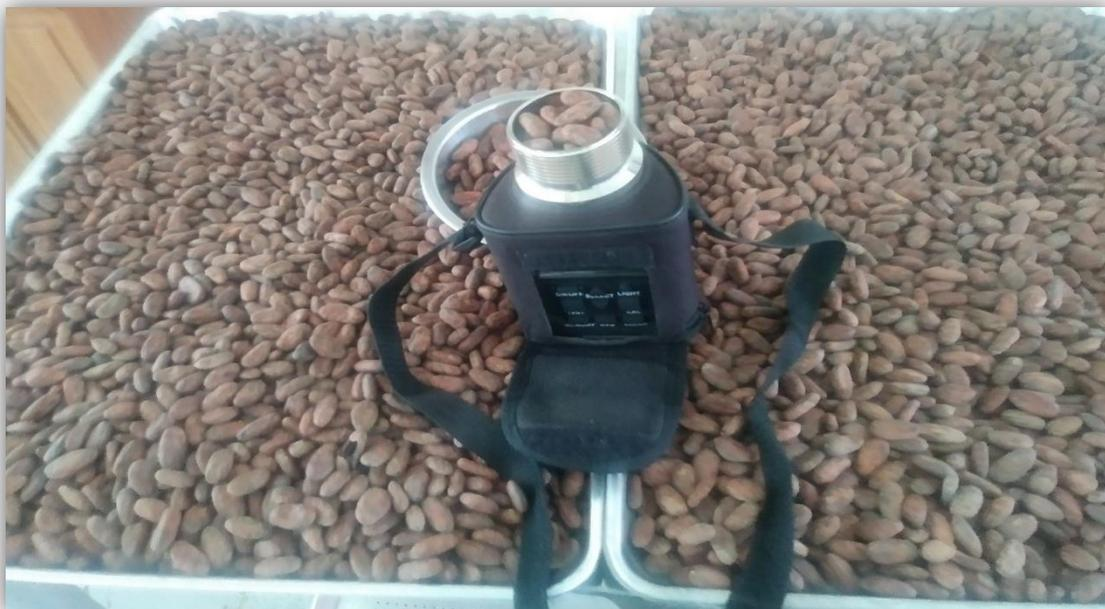
Imagen 83 Medidor de humedad sobre granos de cacao en bandejas
