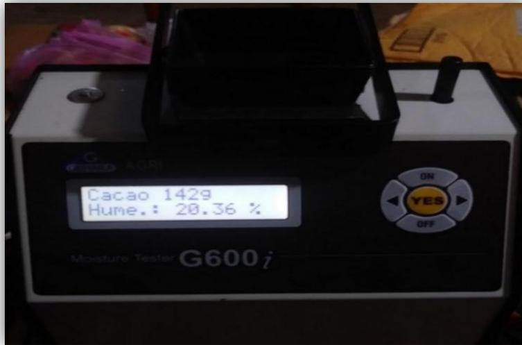
**Imagen 73 medición de humedad interna del grano**
