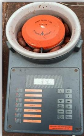
**Imagen 72 medición de humedad en pre-secado**
