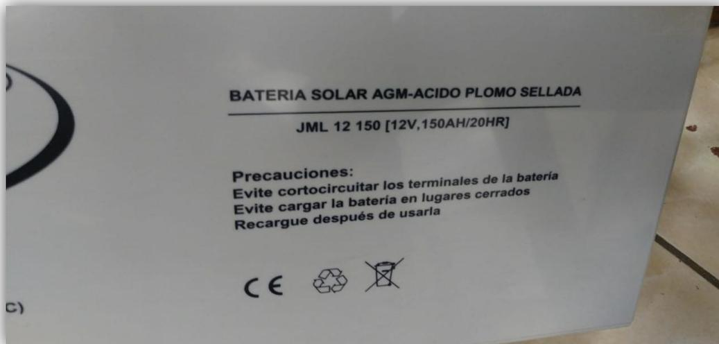
**Imagen 34 batería acido de plomo**
