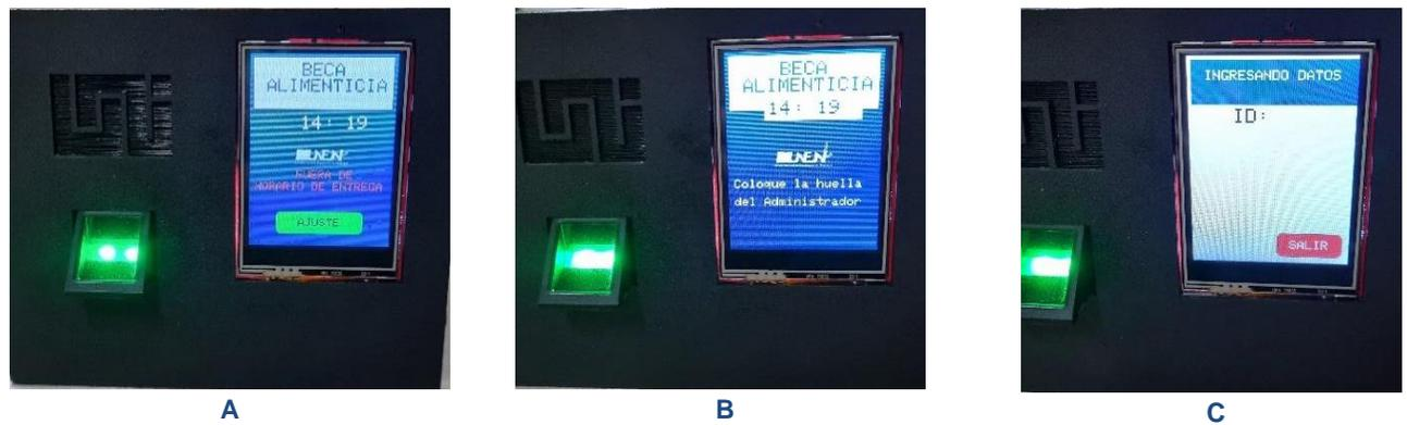
**Figura 13: Huella del Administrador del sistema: (a) Debe ingresar a ajustes por medio de la pantalla táctil, (b) Colocar el dedo en el sensor, así solamente el podrá tener acceso a registrar (c) El sistema muestra en pantalla que se encuentra listo para registrar (Fuente Propia, 2021)**
