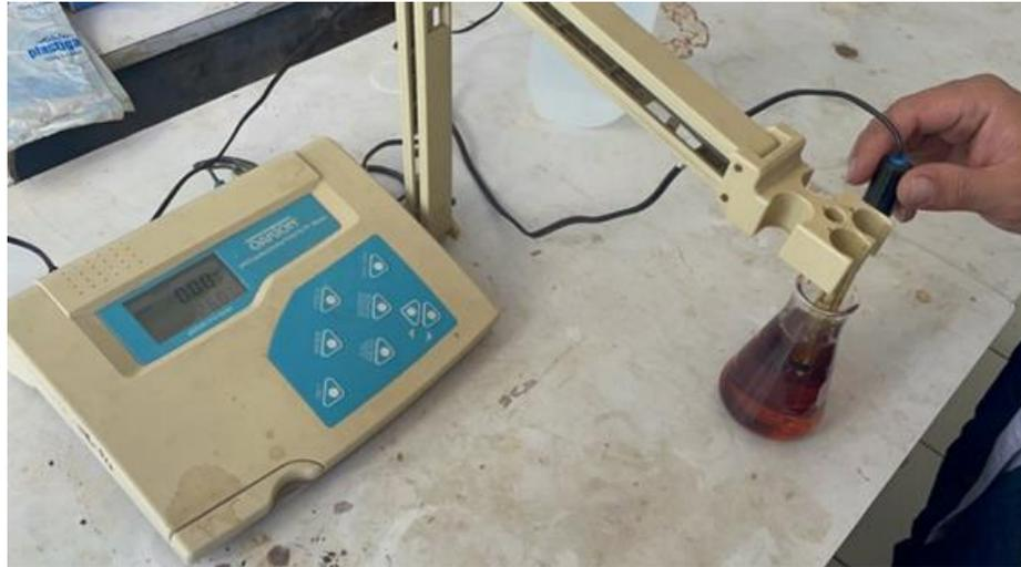
Figura 34 Medidor de conductividad
