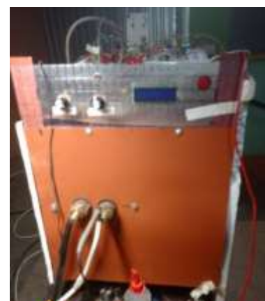
Figura 50 Foto de construcción de Soldador de Arco DC, fuente propia.
