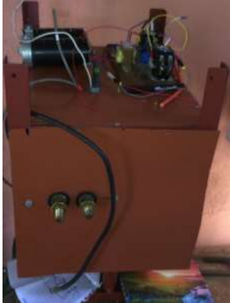
Figura 49 Ensamblaje de Soldador de Arco DC, fuente propia.
