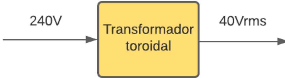
Figura 21 Entradas y salidas del transformador toroidal, fuente propia.
