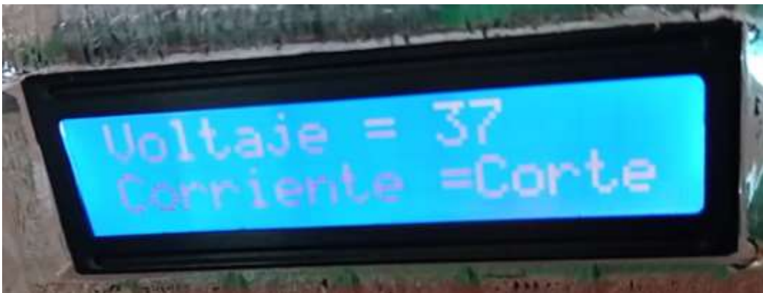
Figura 60 Visualización de configuración de salida del soldador, fuente propia.
