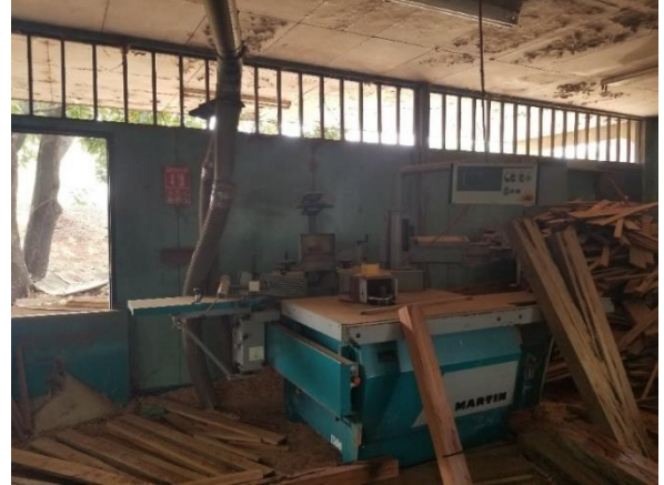
Anexo 6. Máquina perfiladora T27.
