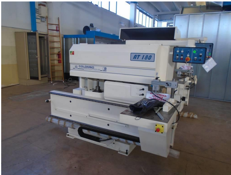
Anexo 42. Espigadora para madera, marca Colombo
