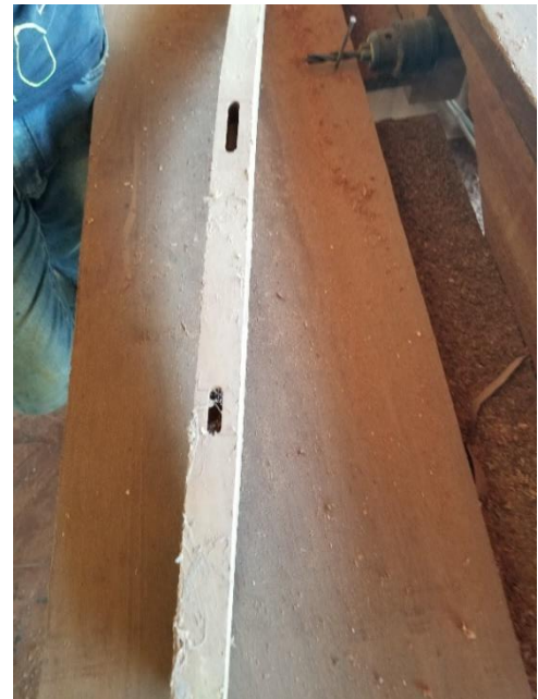
Anexo 24. Pata trasera para silla tipo UNAN escopleada.
