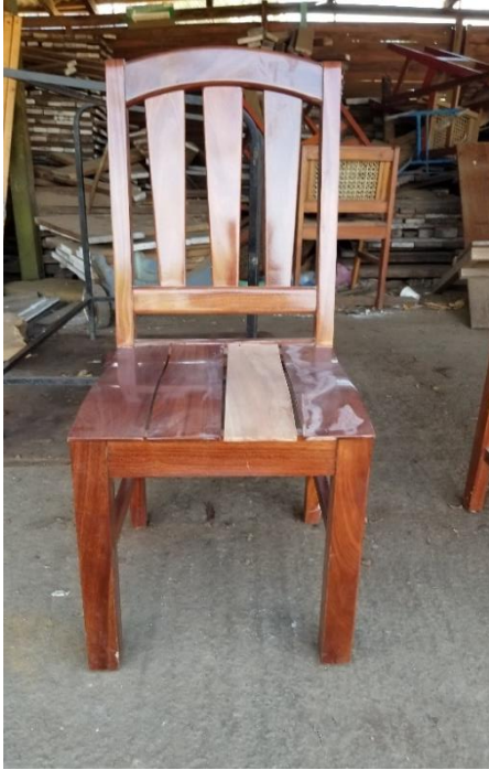
Anexo 13. Silla tipo UNAN, terminada con defecto de asiento con color desigual.
