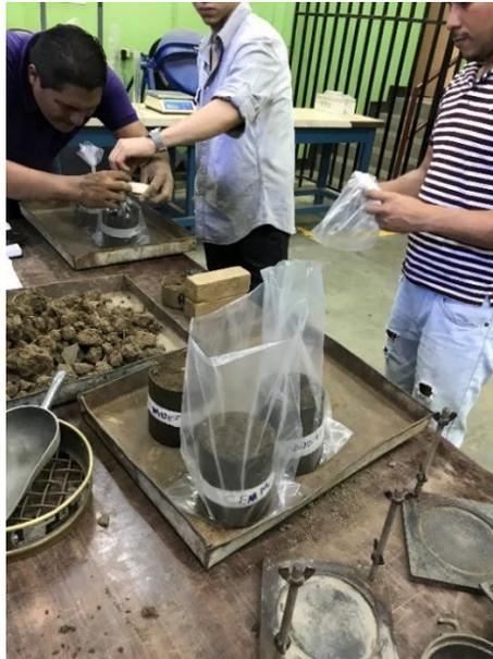
Ilustración 4 confinamiento de muestra para ensayo a compresión no confinada.
