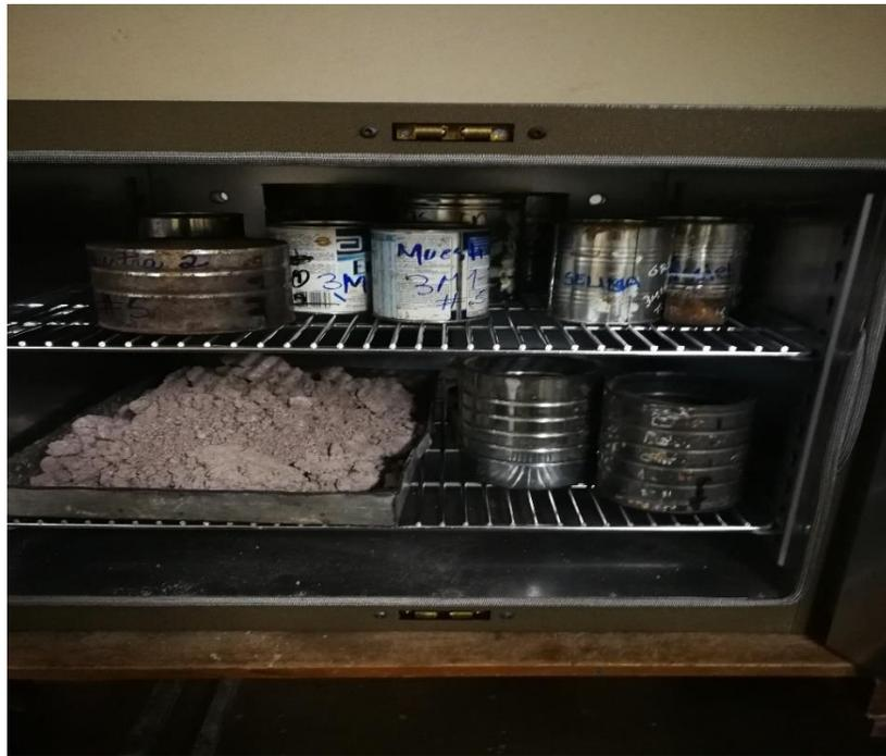
Ilustración 6 secado de las muestras por 24 horas 110 grados.
