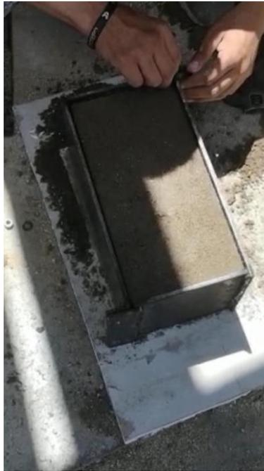
Ilustración 13 tercer molde, de acero con mejor facilidad para la extracción.
