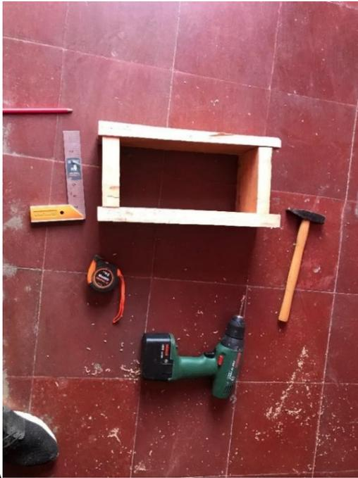
Ilustración 8 primer molde prototipo para bloque de adobe estabilizado.
