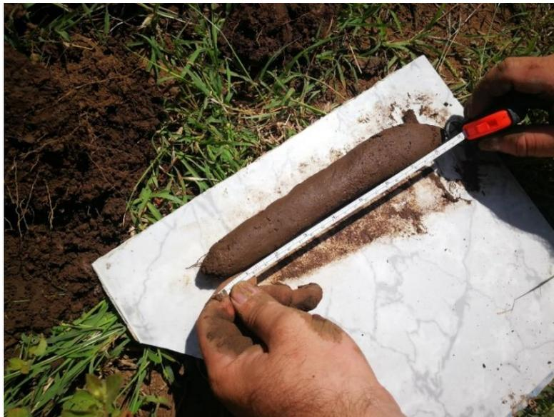
Ilustración 2 Prueba de campo, plasticidad, determinar consistencia preliminar del material.
