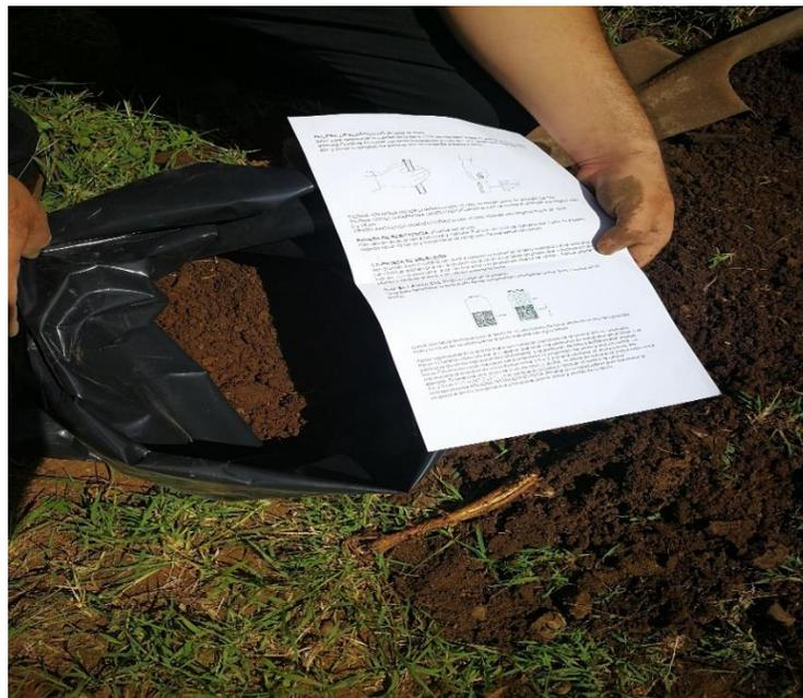
Ilustración 4 Rotulación, clasificación, peso, sellado, y muestreo de banco, del material seleccionado.
