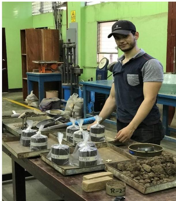
Ilustración 10 muestras para ensayos a compresión no confinada.
