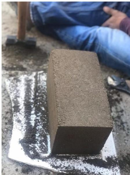
Ilustración 14 muestra de adobe estabilizado final, hecha en marco de acero.
