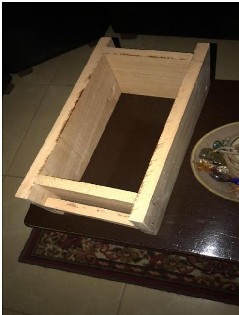
Ilustración 12 segundo molde para adobe estabilizado.
