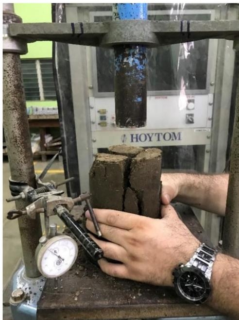
Ilustración 7 ensayo a compresión no confinada, ruptura de muestra.
