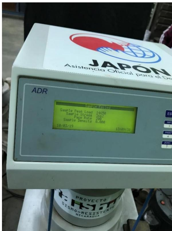
Ilustración 10 prueba a compresión simple, muestras de bloque adobe estabilizado.
