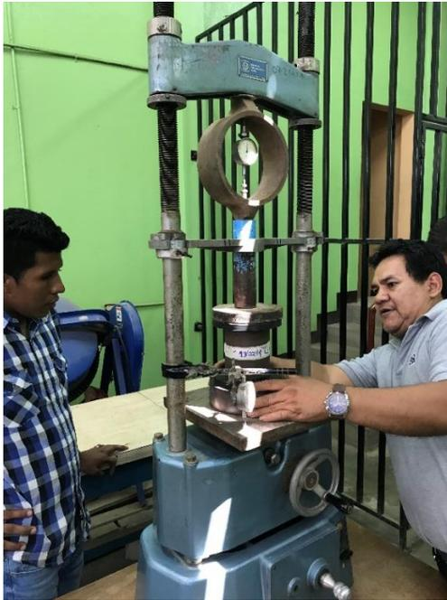
Ilustración 6 calibración de maquinaria para ensayo a compresión no confinada.
