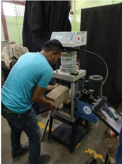
Ilustración 11 colocación de adobe en la prensa para prueba de compresión simple.
