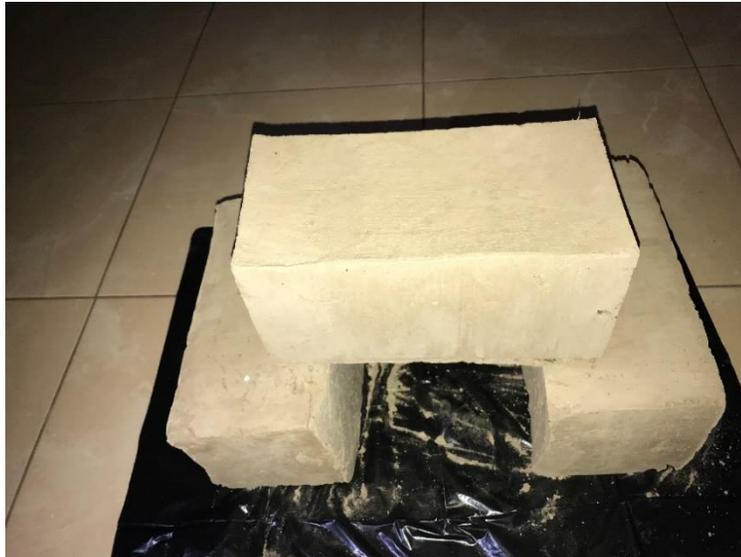
Ilustración 19 prototipó de adobe estabilizado.
