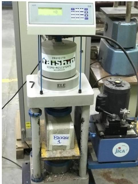
Ilustración 16 prueba de compresión simple en adobe estabilizado.
