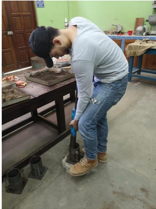
Ilustración 2 compactación ensayo a compresión no confinada.
