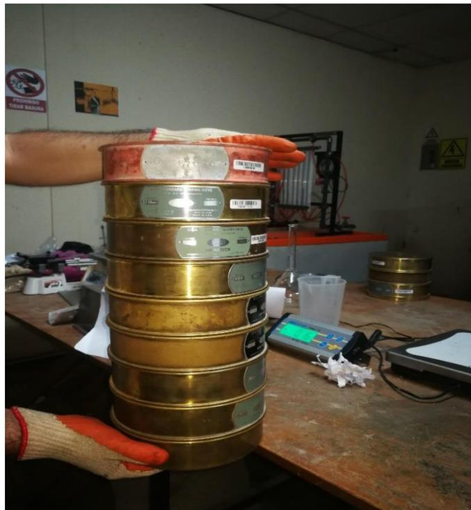
Ilustración 8 tamizado de las muestras, determinación de granulometría.
