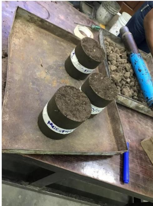
Ilustración 3 Muestras de para ensayos a compresión no confinada.
