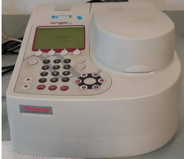
Figura 5.4 Espectrofotómetro utilizado para la medición de absorbancia de las distintas disoluciones
