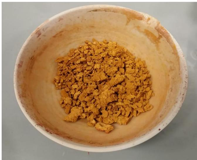
Figura 5.2 Resultado de la calcinación, perovskita  $LaFeO_3$
