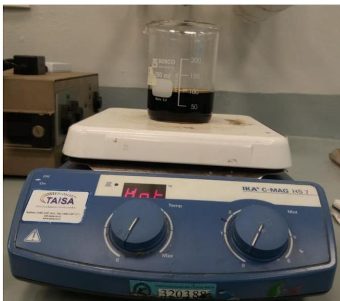
Figura 5.1 Preparación de la perovskita  $LaFeO_3$  mediante el método Pechini
