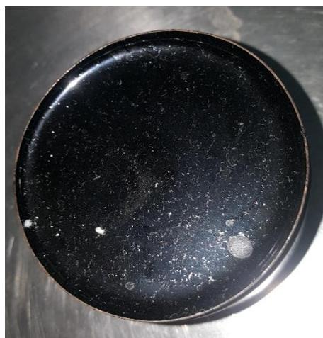
**Figura C.9.6.** Muestra de cemento asfáltico obtenido del ensayo de residuo por evaporación
