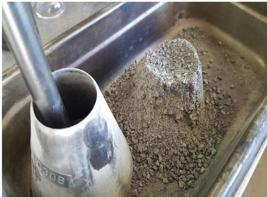
*Figura C.9.2. Agregado pétreo en condición saturada superficialmente seca*
