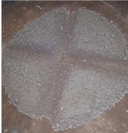
*Figura C.9.1. Muestra de agregado pétreo cuarteado.*
