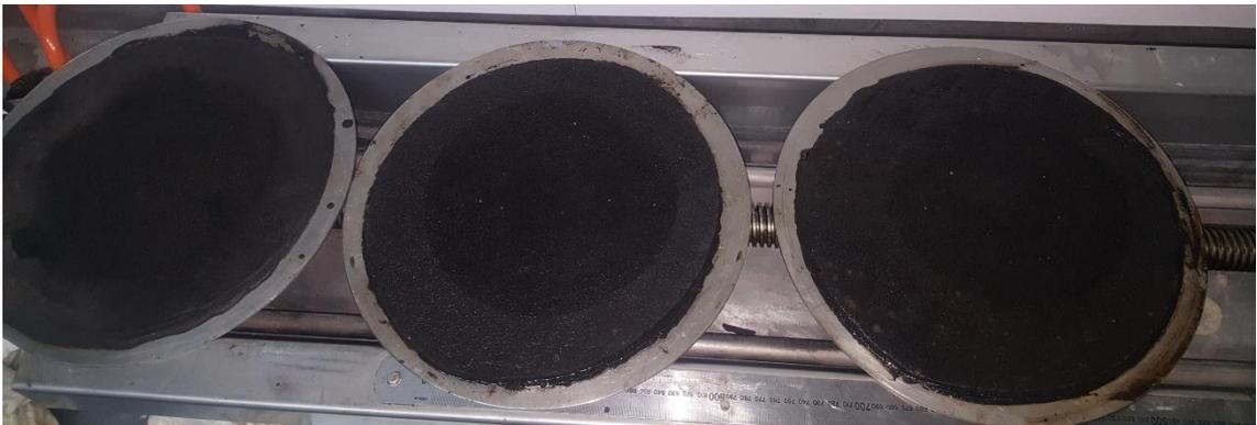
**Figura C.9.8.** Muestras post ensayo de desgaste por abrasión húmeda
