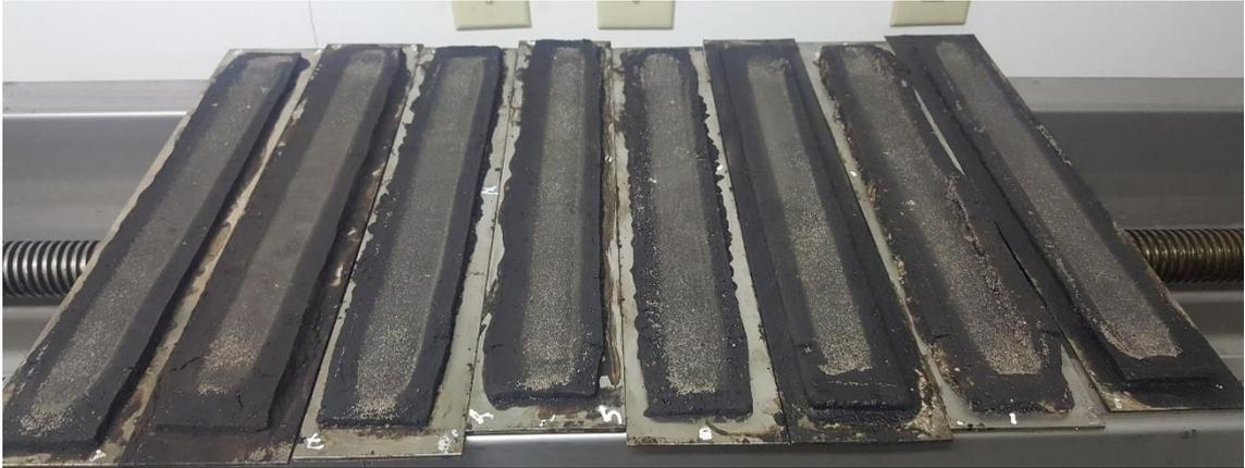
**Figura C.9.7.** Muestras post ensayo de rueda cargada y adhesión de arena
