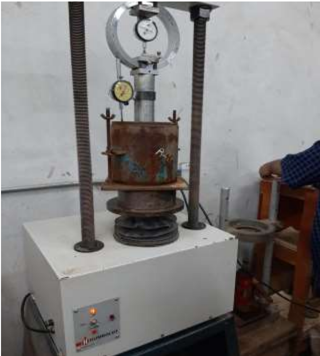
Fotografía 8: Prueba de penetración al CBR.
