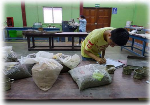
Imagen No. 10. Ensayo de Granulometría
