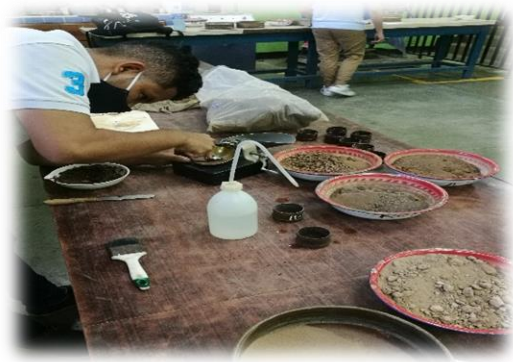
Imagen No. 11. Ensayo Límites de Atterberg
