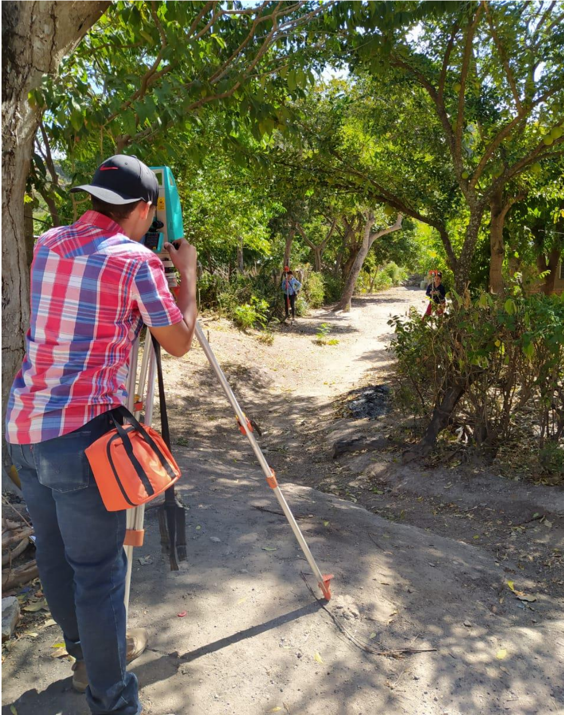
Ilustración VIII-8. Uso de estación total para realizar levantamiento topográfico
