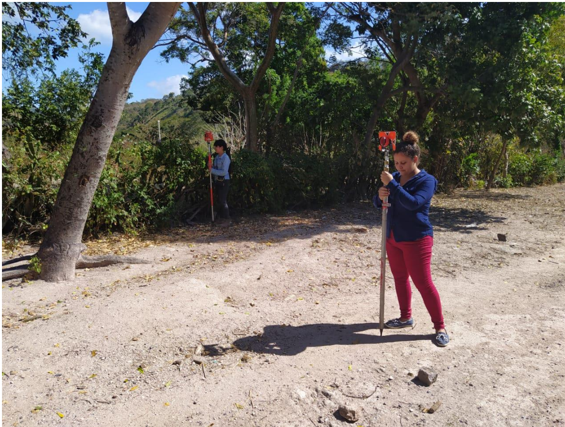
Ilustración VIII-7. Levantamiento topográfico con estación total
