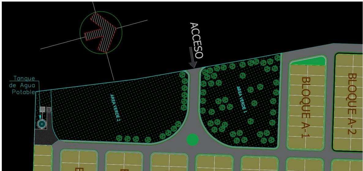
La imagen No.4 es una captura de pantalla del plano en CAD que muestra el acceso a la urbanización, áreas verdes y ubicación de Tanque de Agua potable ubicado en el costado suroeste del terreno de la urbanización.
