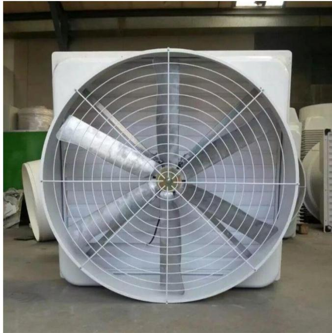
Figura 10: Ventilador industrial para enfriamiento del producto terminado.
