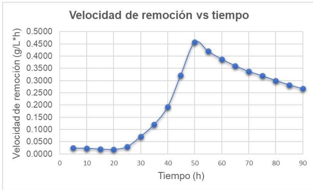
Figura 6.23: Velocidad de remoción en suspensión acuosa por el consorcio aplicado a una concentración inicial del 1% (v/v) de diésel a una temperatura de 30°C.
