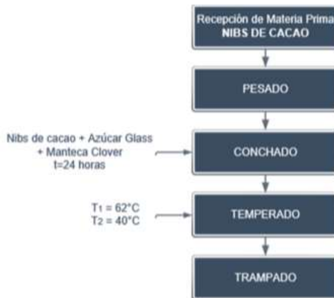
Figura 8: Diagrama de Bloque de Producción de Cubierta de Chocolate.
