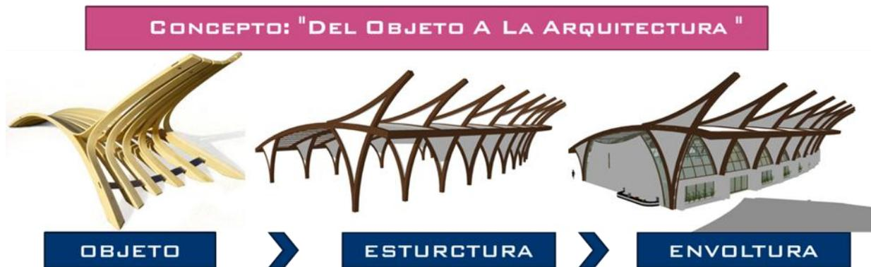
El concepto de diseño del edificio terminal del aeropuerto de Corn Island es arquitectónicamente innovador y llamativo visualmente, ya que se inspira en la forma y estructura de una silla de descanso.
