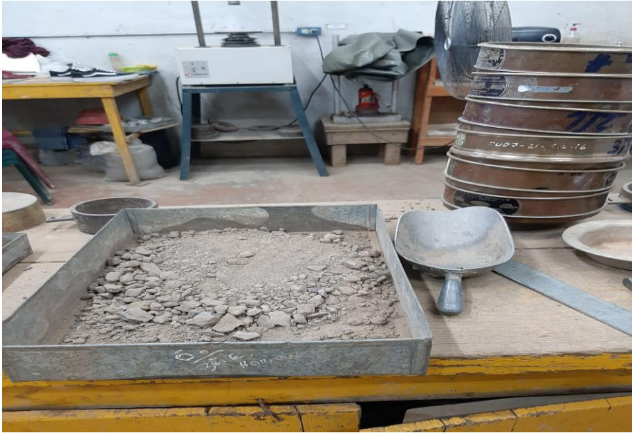
Fotografía 5: Ensayo de granulometría
