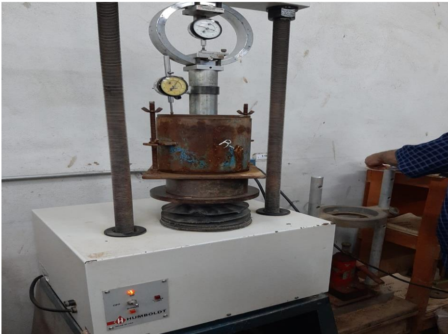
Fotografía 6: Ensayo de CBR
