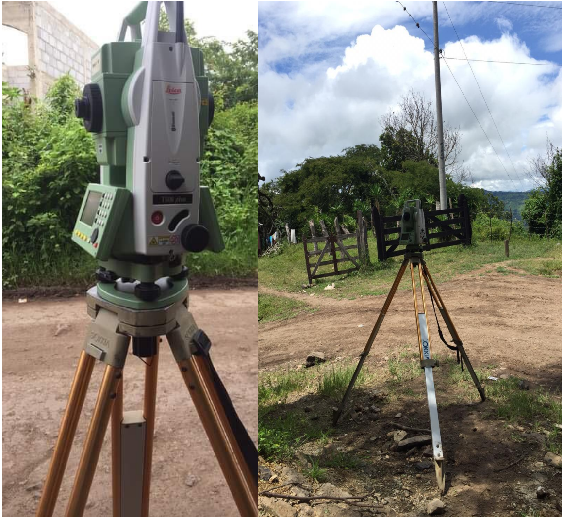
Fotografía No 7: Estación total utilizada para el levantamiento topográfico
