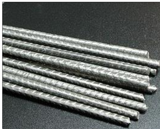
Figura 7. Acero de refuerzo
