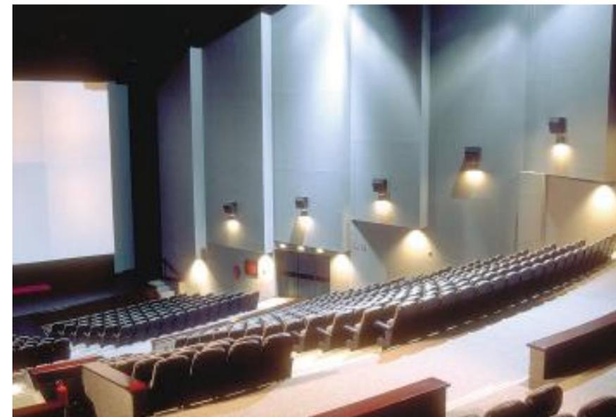
Foto # 3: Reflectores laterales generadores de primeras reflexiones hacia la zona de público
