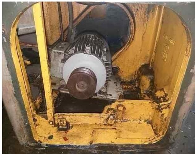
Correa del motor con desgarramiento en su superficie, así como el estiramiento de la misma que perjudica las rpm de trabajo del torno.
