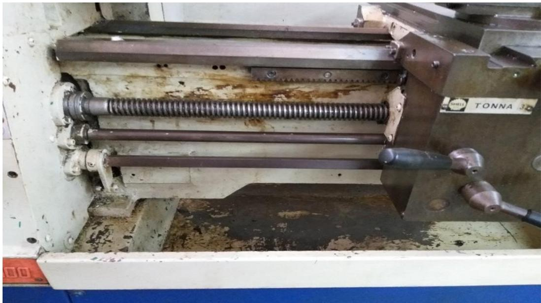
**Figura 10. Eje roscado y automático**
