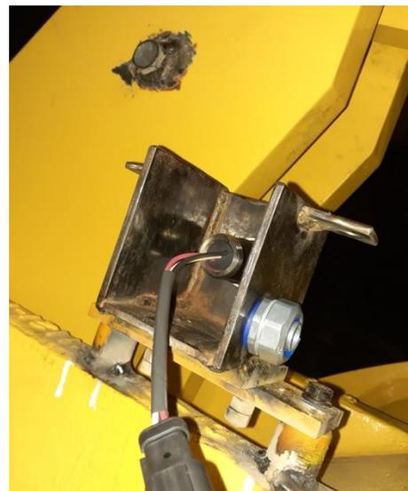
*Figura A.18. Izq. Ensamble de los soportes en el brazo de alzado en su punto de interés para montaje. Der. Prueba de ubicación de las piezas y placa de contacto.*
