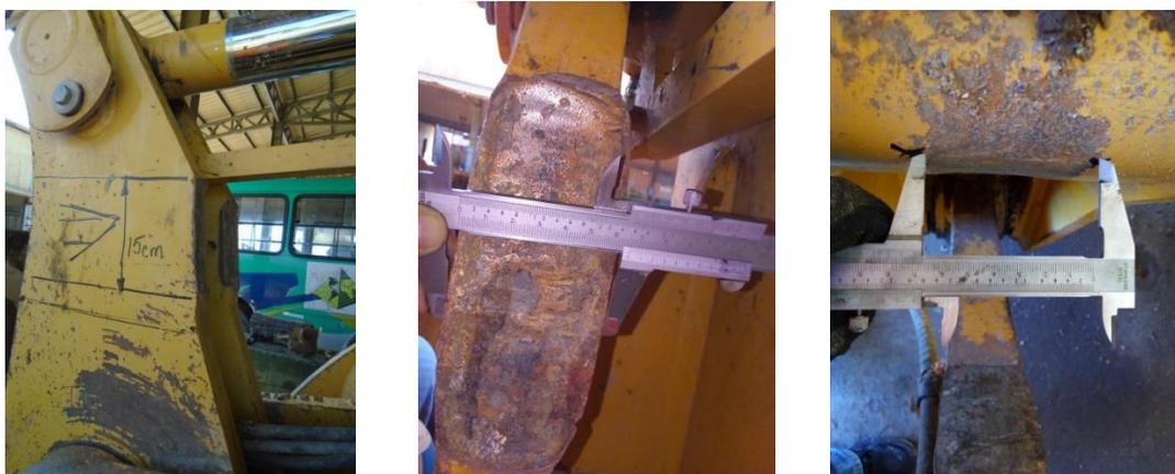
*Figura B.1. De izquierda a derecha: a) Impacto en el Bellcrank, b) deformación de 15 milímetros, c) impacto entre el cucharón y en eslabón del cucharón.*
