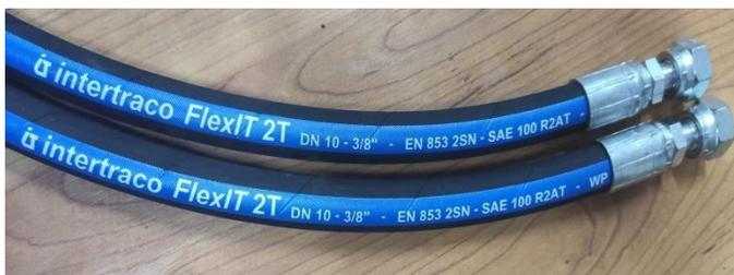
*Figura 6.15. Mangueras hidráulicas de conexión entre la válvula, tanque y control central.*
