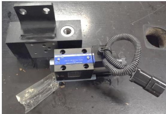
*Figura 6.14 Solenoide, válvula direccional y tornillos del kit de la electroválvula.*
