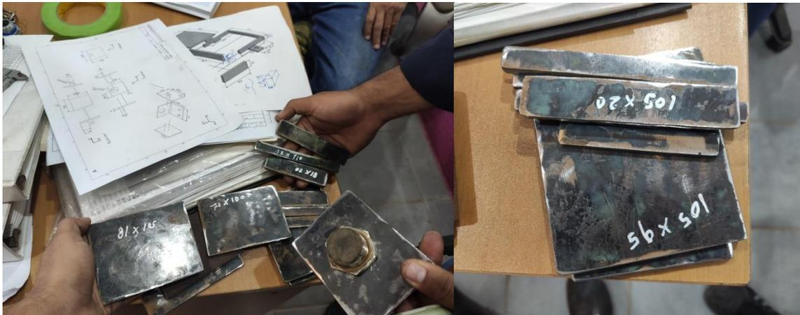
*Figura A.14. Revisión de las piezas cortadas con plasma, incluyendo el ensayo del posicionamiento del sensor.*
