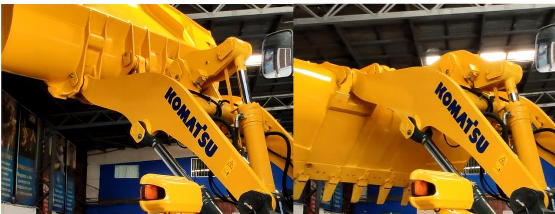
*Figura A.20. Prueba de funcionamiento. Se observa que no hay contacto entre el Bellcrank y el brazo, y que existe suficiente espacio de seguridad.*
