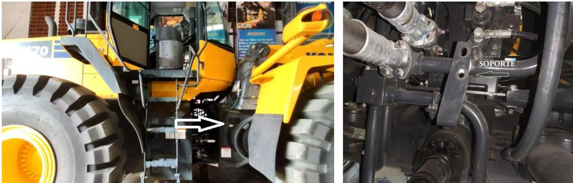
*Figura A.8. Lugar de montaje de electroválvula.*
