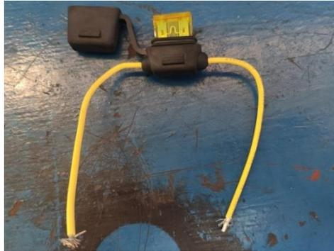
*Figura 6.22 fusibles y base porta-fusible.*
