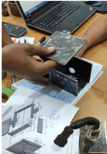
*Figura 6.26. Corte y unión de la caja de protección del sensor.*
