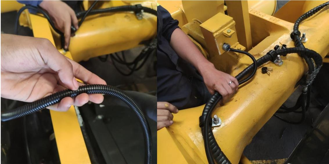
*Figura A.19. Izq. Instalación de protección al cable TSJ, Der. Fijación de línea de cables con bridas a la estructura.*
