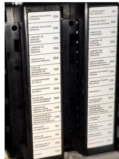
Figura 6.18 Caja de fusibles número 2 del diagrama del circuito eléctrico (1/10) y Figura 6.19 Cajas de fusibles 1 y 2, a la izquierda la número 2.
