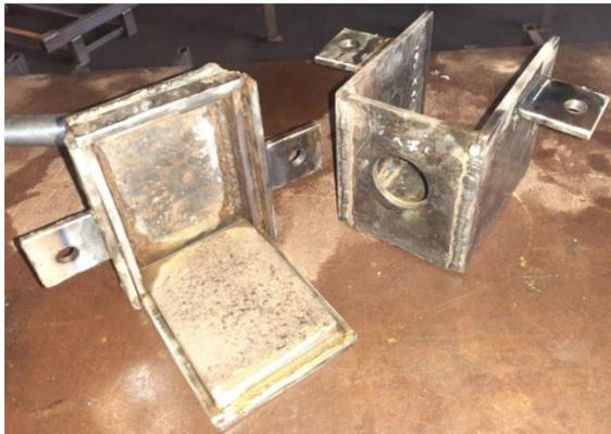
*Figura A.15. Operación de fijación por soldadura de borde y de filete.*
