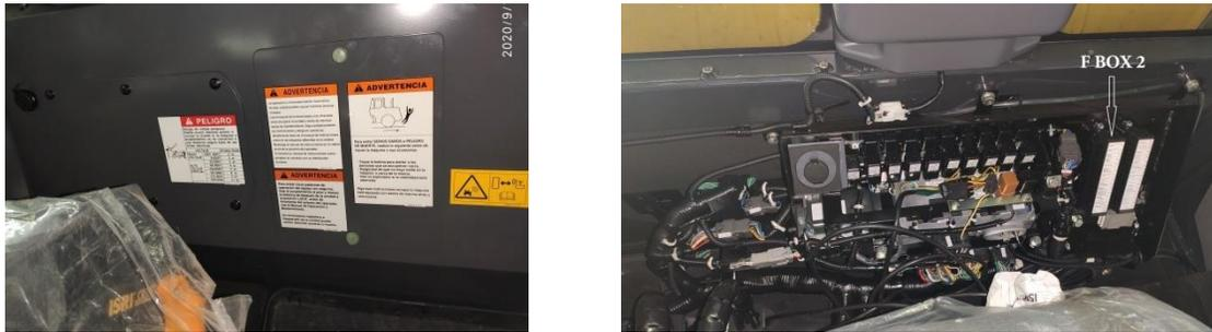
*Figura A.2. Panel eléctrico y caja de fusibles número 2.*
