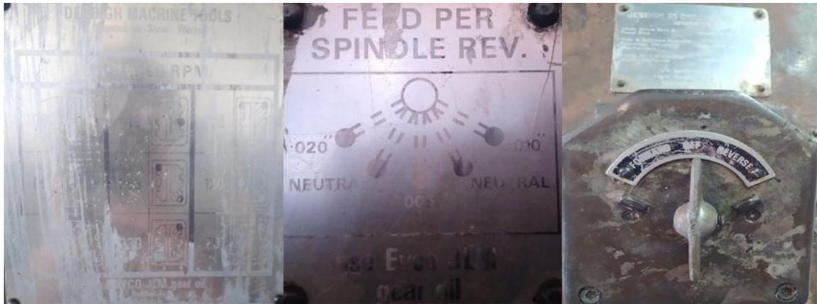
**Figura 19.** Diagrama de velocidades, avance y selector.
