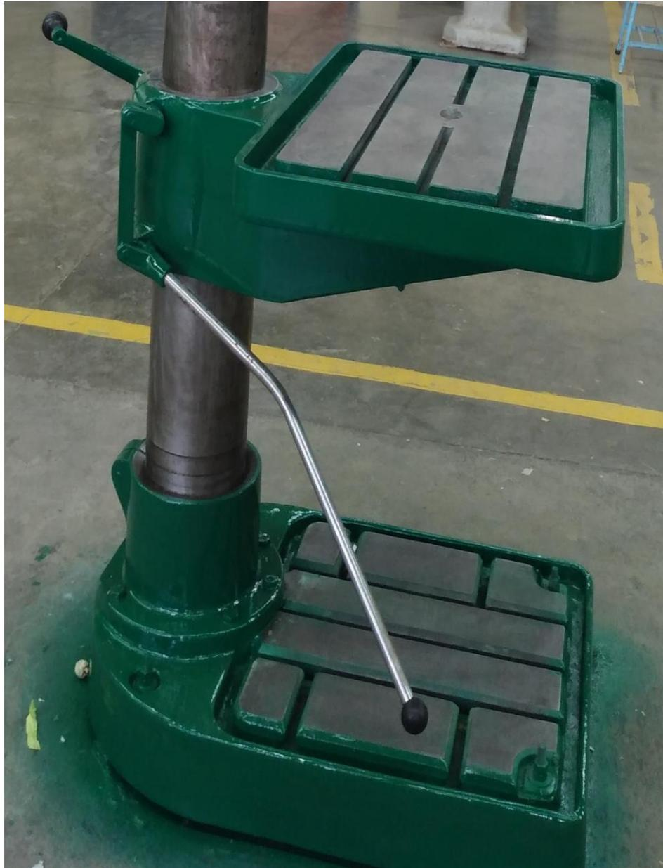
**Figura 39.** Palancas de bloqueo de la mesa de trabajo.
