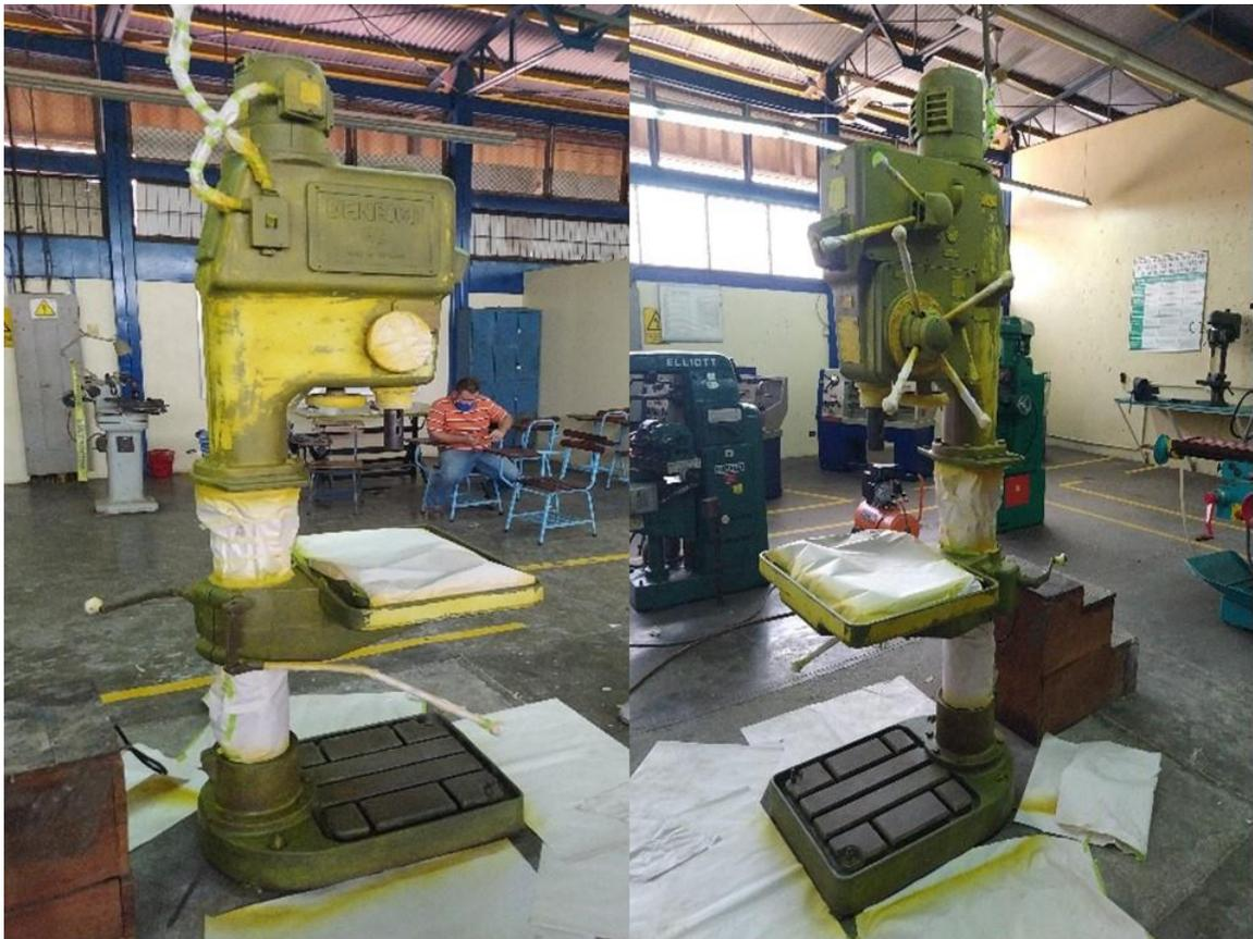
**Figura 16.** Aplicación de base de anclaje
