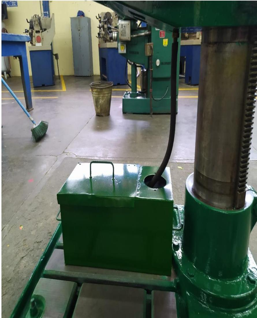
**Figura 22.** Depósito para el fluido de corte
