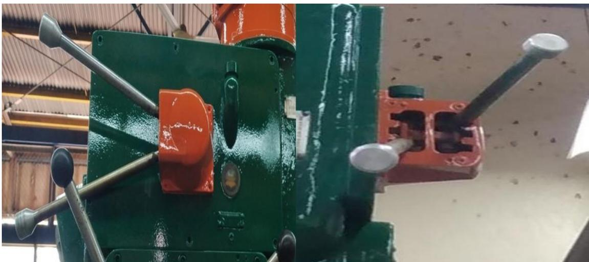
**Figura 41.** Palancas para seleccionar velocidades.
