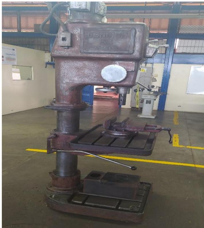
**Figura 15.** Taladro después de removida la pintura.
