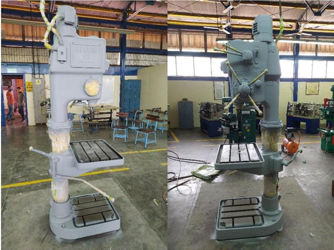
**Figura 17.** Aplicación de base acrílica
