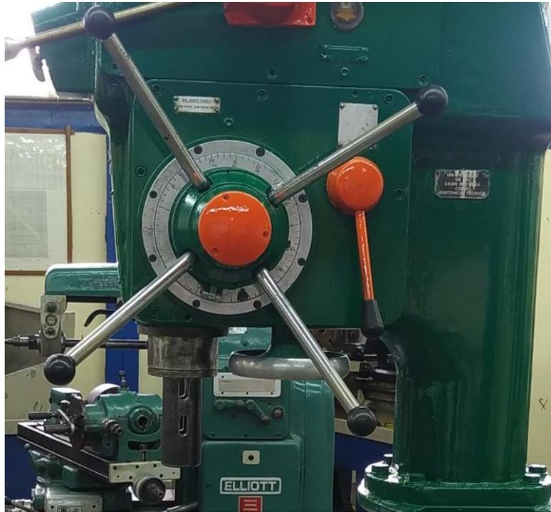
**Figura 28.** Manivela con sus cuatro palancas.
