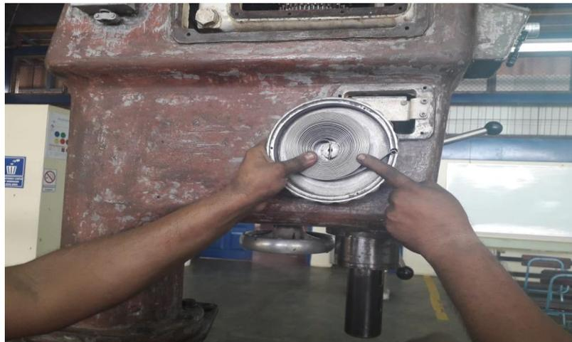
**Figura 26.** Muelle de retorno con fallas corregidas
