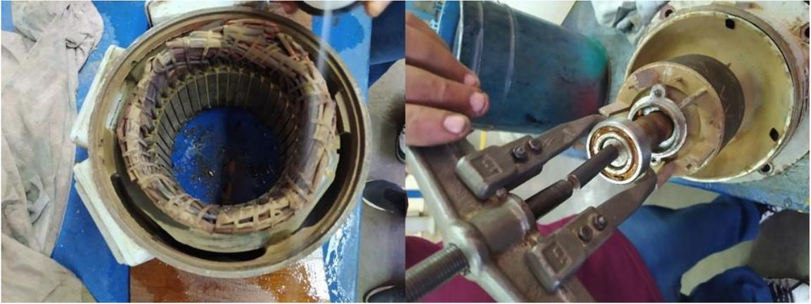
**Figura 12:** Bobina y balineras del motor eléctrico.
