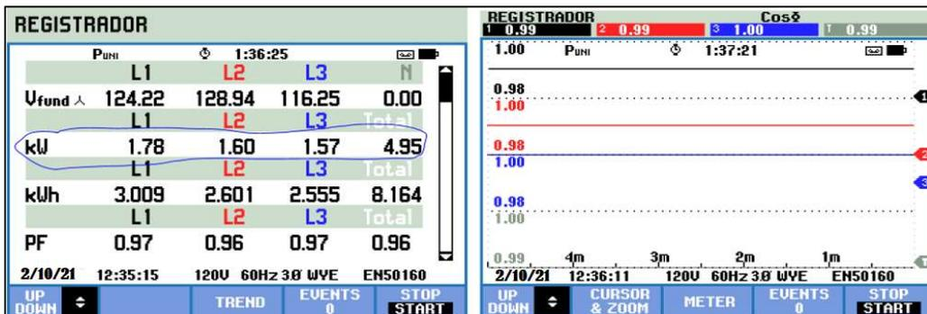
Figura 10: Medición del factor de potencia con el fluke 438 II
