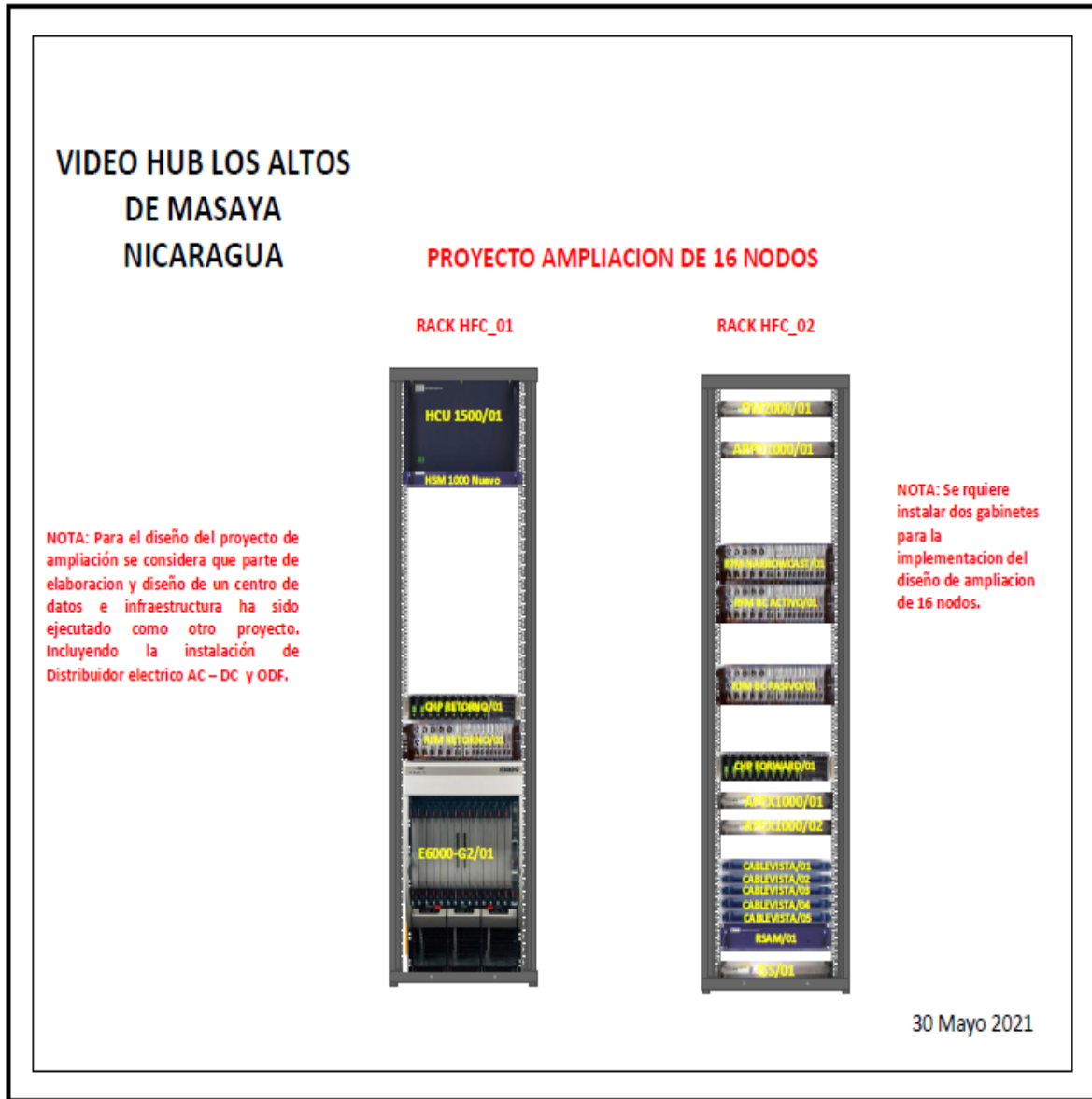
Figura 16. Facial de equipos empleados en el diseño de una red HFC – Ampliación de 16 nodos. (Elaboración propia).
