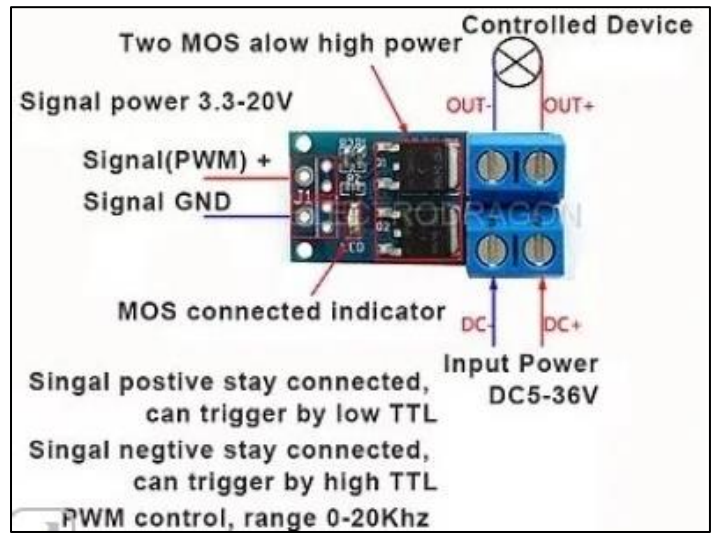
Figura 11: Conexiones del módulo de conmutación
