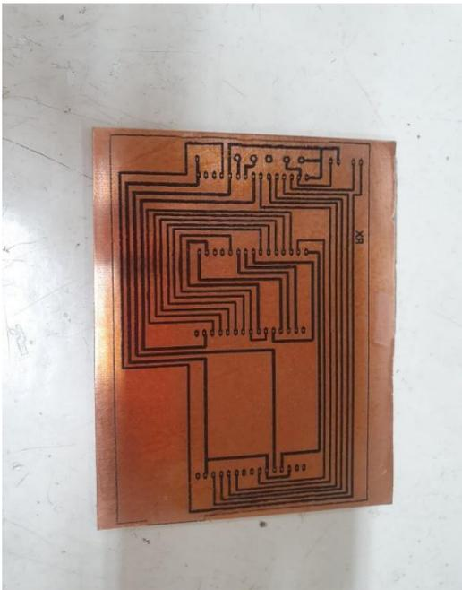
*Ilustración 3* tarjeta PCB luego del planchado
