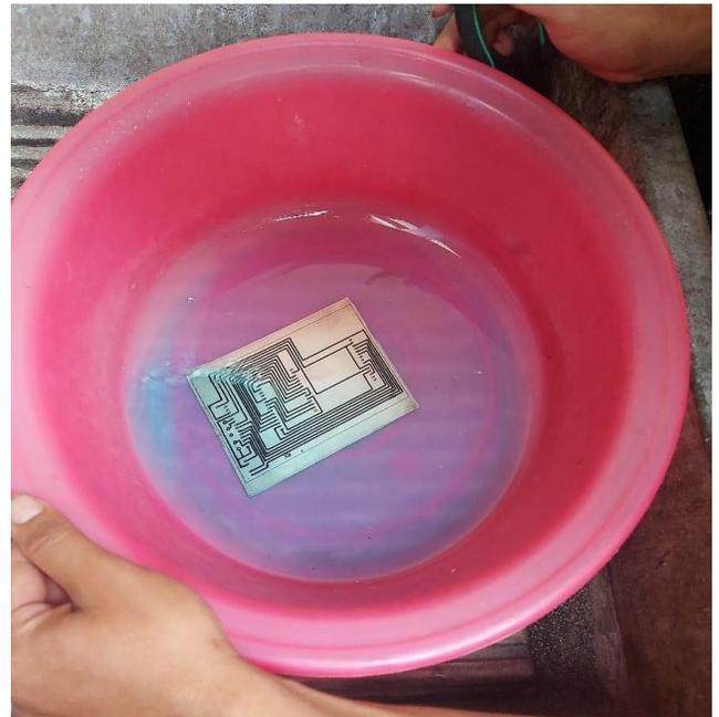
*Ilustración 4* Placa en disolución con ácido nítrico
