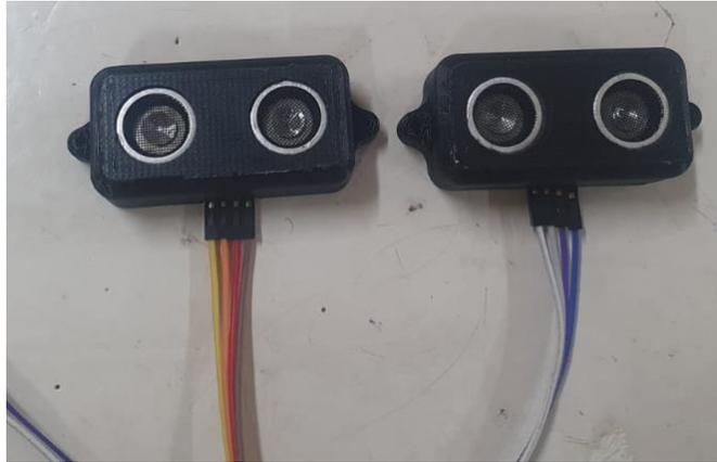
Fuente propia 2021. Sensores ultrasónicos con case diseñado en sketchup.
