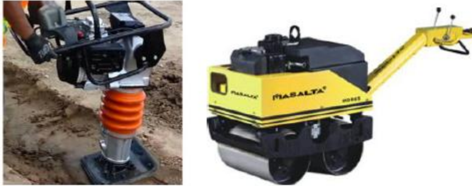
Figura N°31. Apisonador y Rodillo de compactación.
