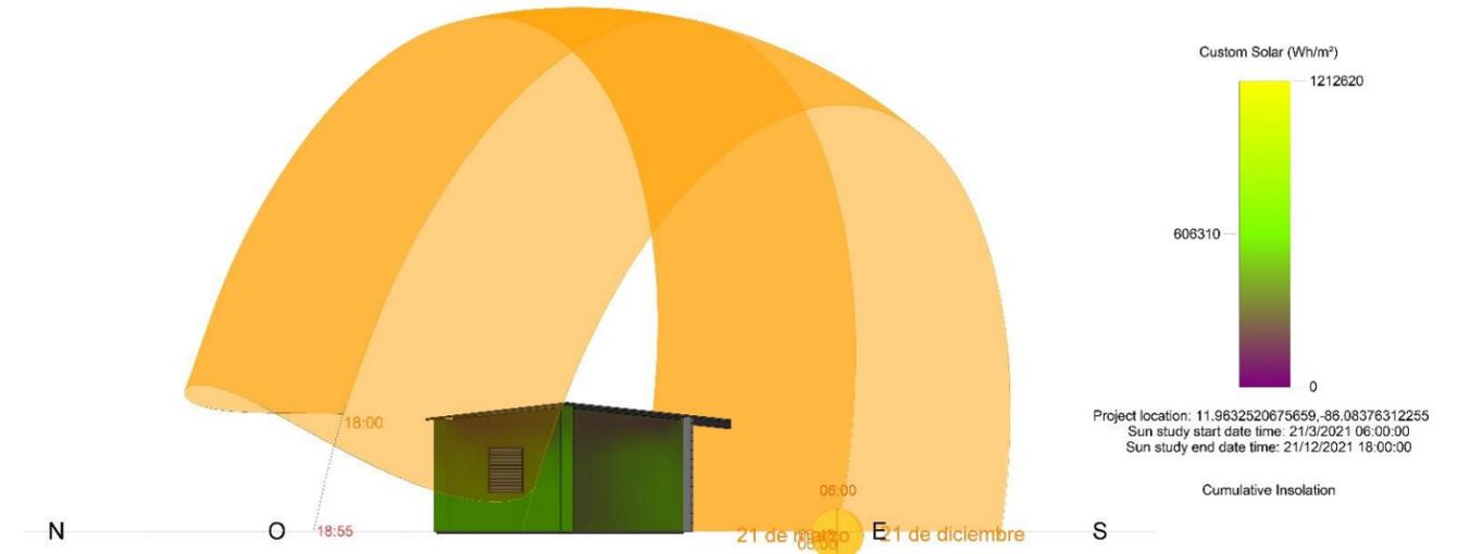
Ilustración 106. Estudio de radiación solar sobre la fachada sur oeste en las fechas estudiadas. Creada por las autoras.
