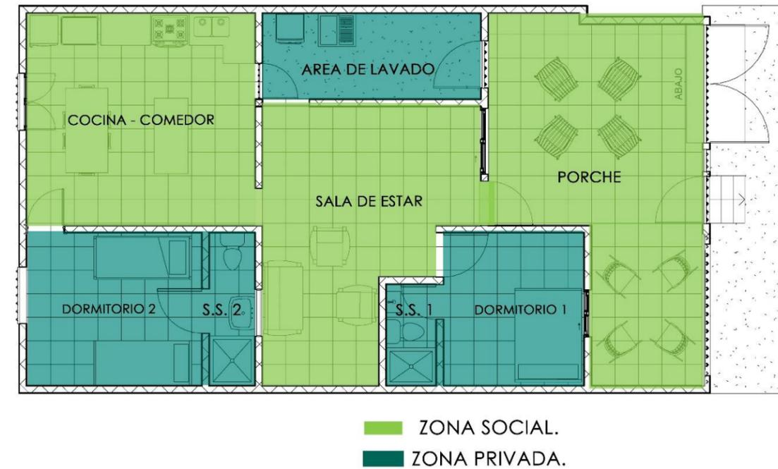
*Ilustración 73. Planta de Zonificación de la Vivienda C-12.*
