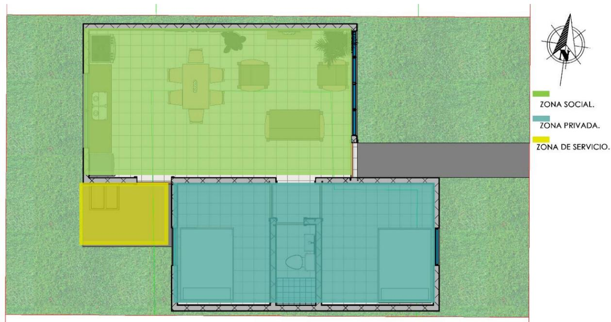
Ilustración 129. Propuesta de Planta de Zonificación Vivienda Modelo C-12.
