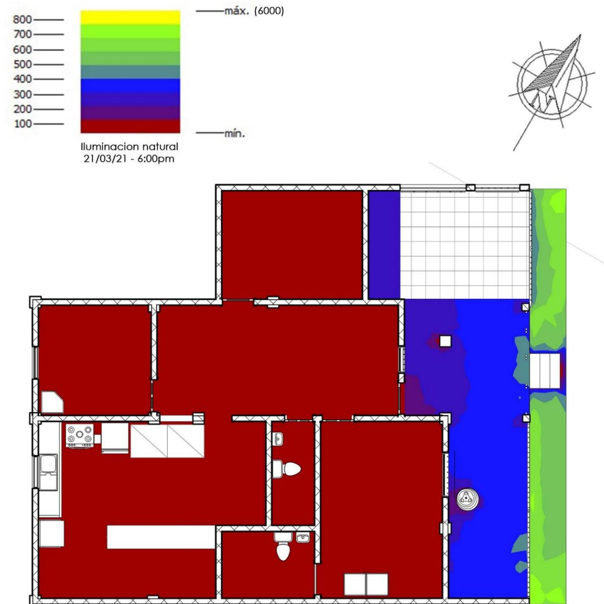
Ilustración 121. Estudio de iluminación natural en equinoccio de primavera - 21 de Marzo de 2021 a las 6pm. Realizado por las autoras en el software de Revit a través de Insight Lighting.
