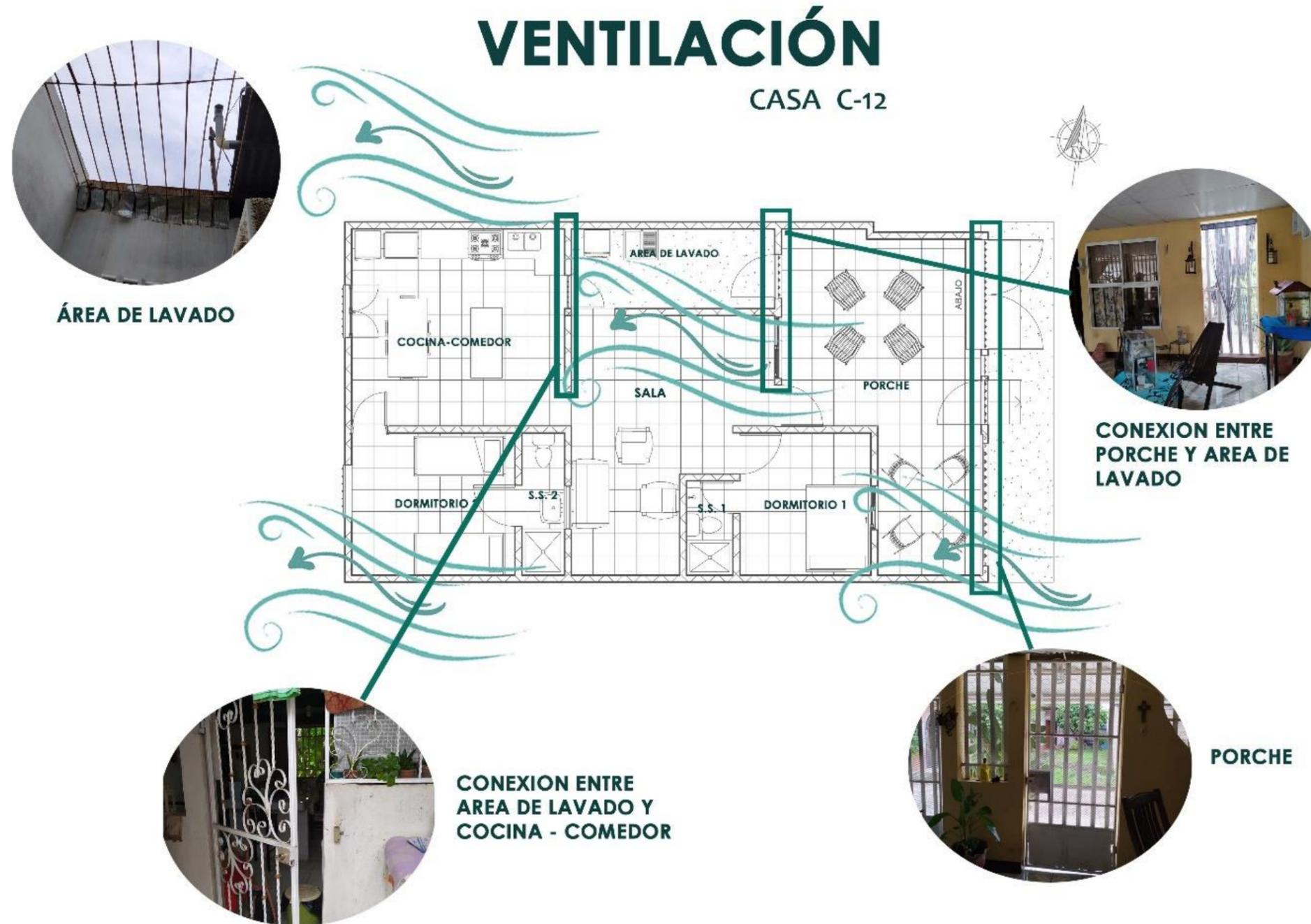
*Ilustración 90. Planta Arquitectónica Vivienda C-12 con afluencia de ventilación Este.*
