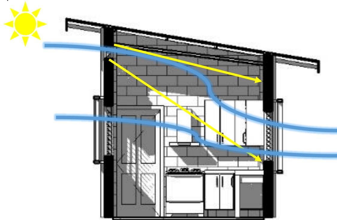
*Ilustración 163. Corte de área de cocina donde se evidencia la entrada de aire y luz natural. Elaborado por autoras a partir de interfaz Revit.*
